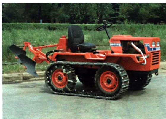
д) МГТ з двокорпусним плугом ПН-2-40
