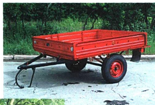
а) Т-0,2.01 з вантажною платформою
