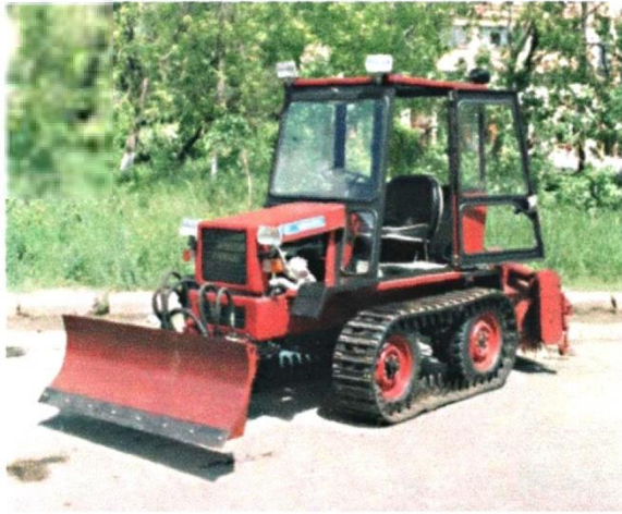
а) МГТ з бульдозерним відвалом
