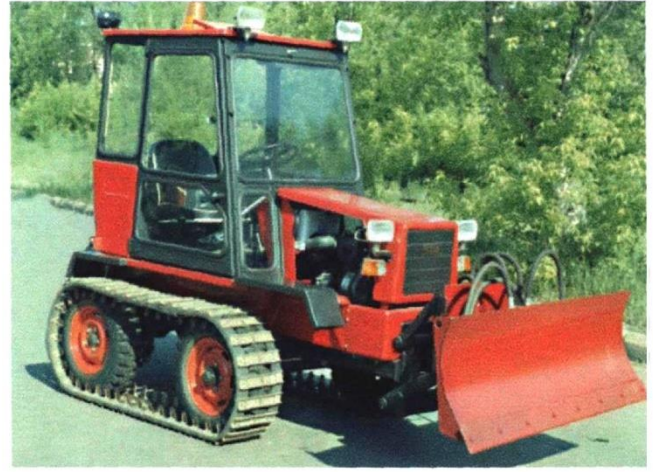
а) МГТ з бульдозерним відвалом
