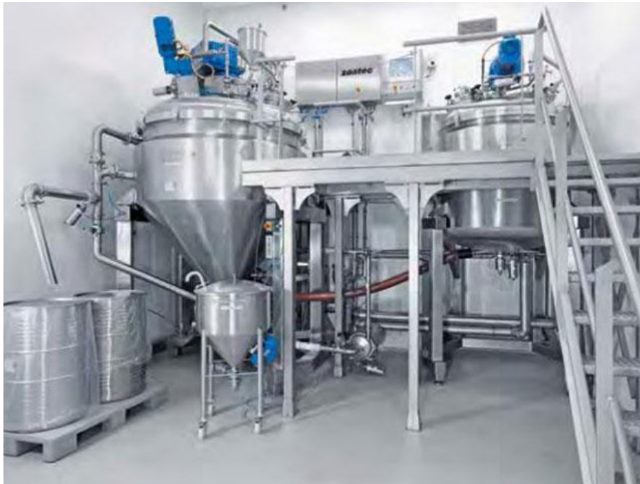
Рис. 2.3. Технологічна лінія по виробництву сиропів для дітей
