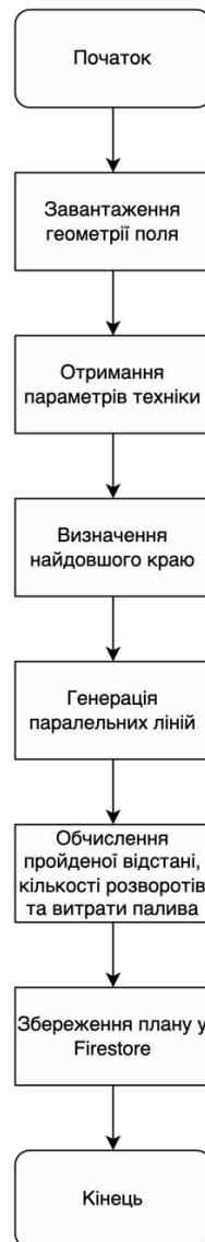
Рис. 9 Блок-схема алгоритму побудови маршруту руху техніки
