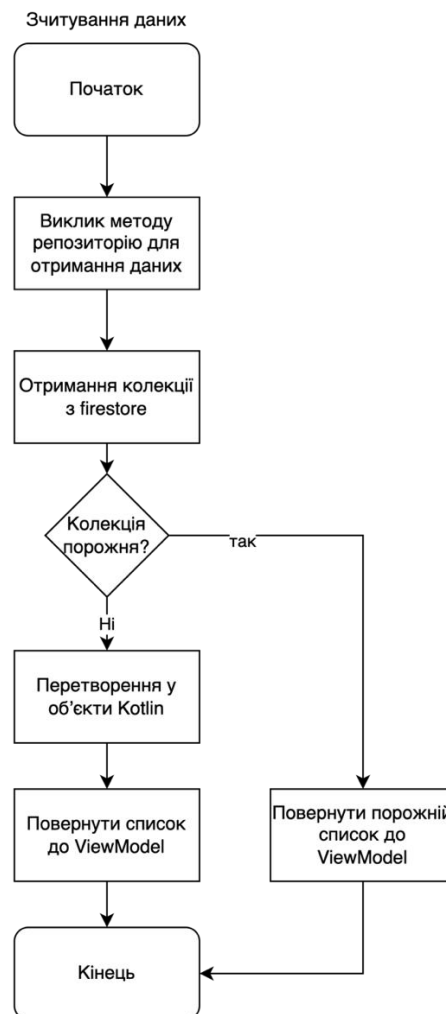
Рис. 5 Схема зчитування даних
