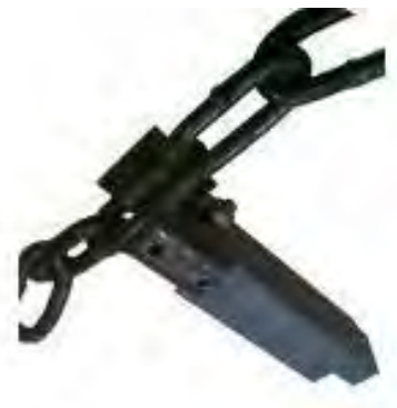
Рис. 6.5 Кріплення скребка конвеєра КСГ-7
