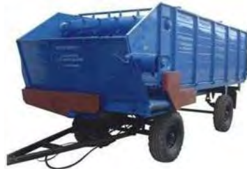
Рис. 11.4. Кормороздавач тракторний КТУ-10А
