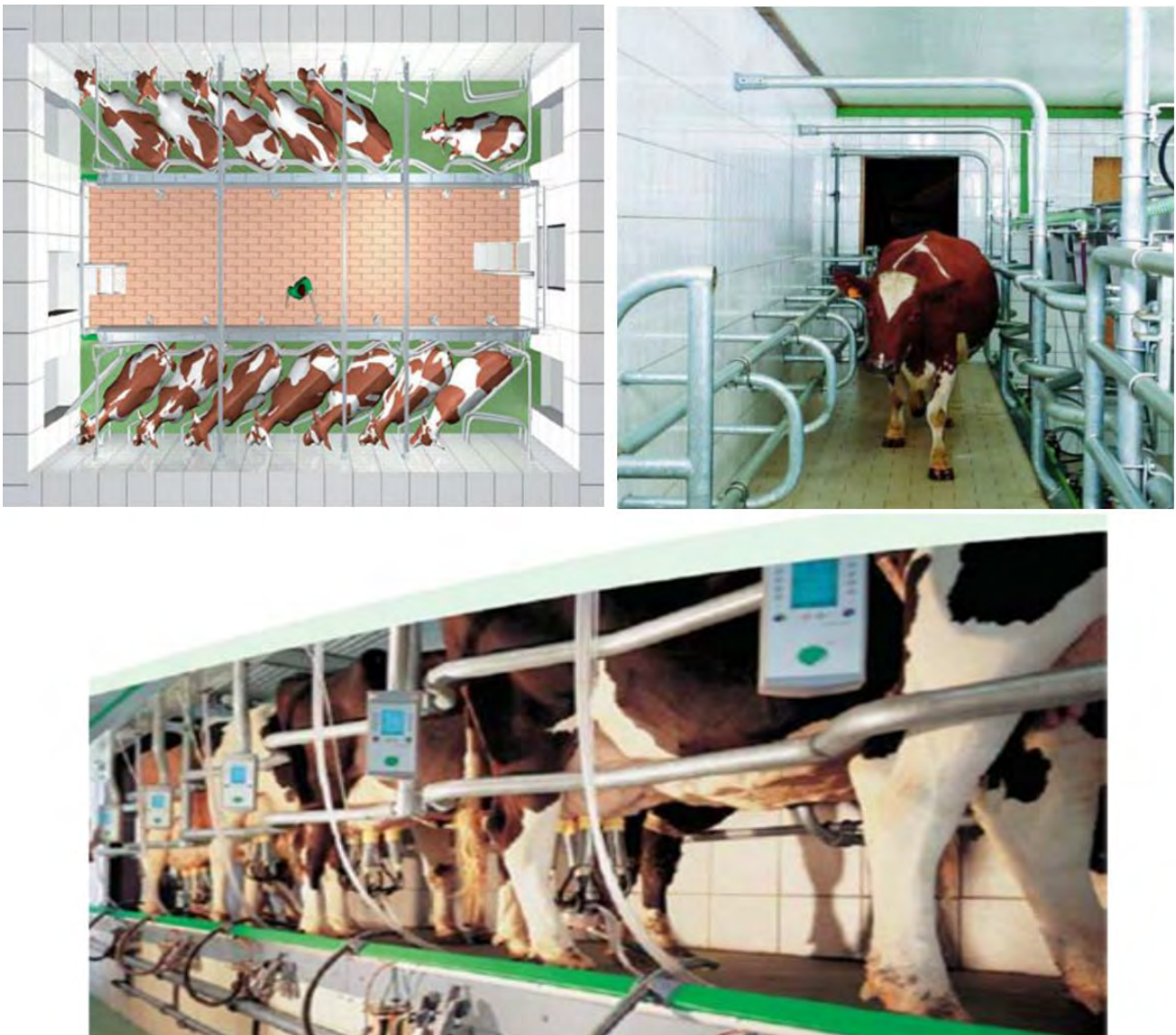
Рис. 8.16. Схема розміщення корів на доїльній установці «Ялинка»
