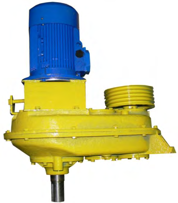
Рис 6.4 Урухомник горизонтального конвеєра НІ 00.92:
