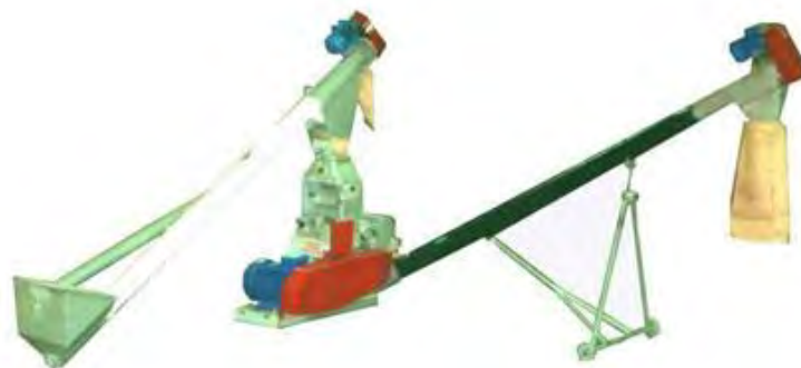
Рис. 11.28. Лінія для механізованого подрібнення зерна з використанням дробарки ДМ-4
