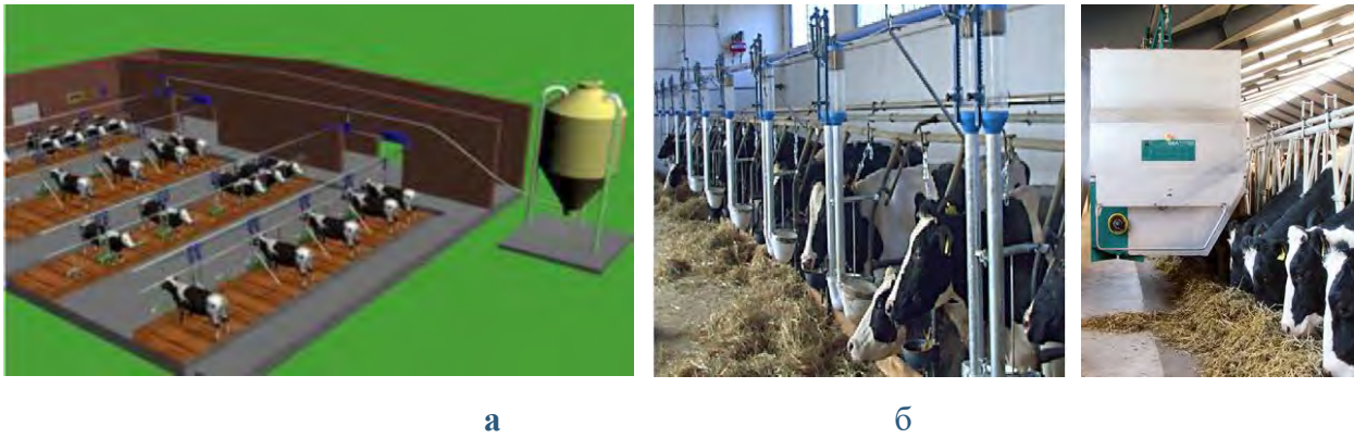
Рис. 11.27. Система дозованої годівлі комбікормом за прив'язного утримання ВРХ з використанням індивідуальних дозаторів (а), рейкового кормовагону (б).
