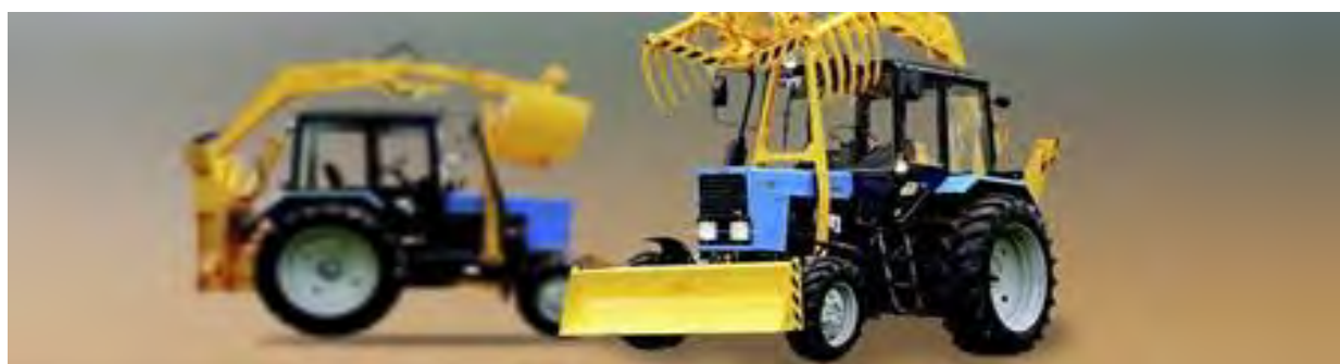
Рис. 11.1. Навантажувачі а – МТЗ-922.5 (навісне обладнання ПКУ-0,8); б – МТЗ-80 (навісне обладнання ПК-10Е (ПБМ-800)); в – МТЗ-80 (навісне обладнання ПЭ-0,8 (ПМН-30Е))
