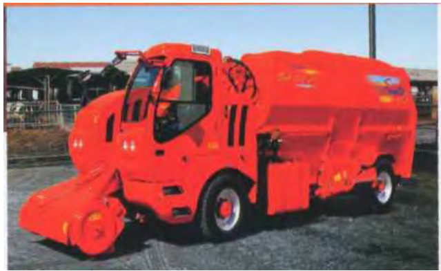
Рис.12. Комбінований агрегат для приготування і роздавання кормів SAMURAI 5 Self
