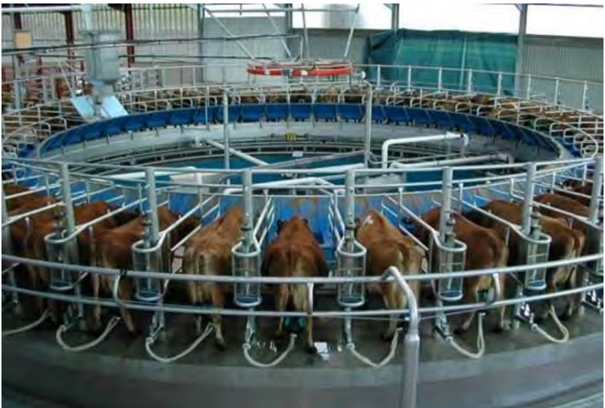
Рис. 8.17 Автоматизований доїльний агрегат УДА-100 «Карусель»
