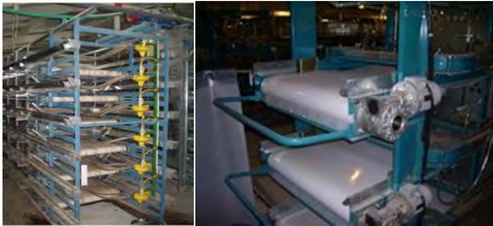
Рис. 11.14. Конвеєрна п'ятиярусна система видалення посліду
