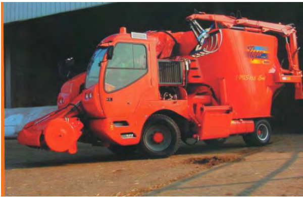
Рис.11. Комбінований агрегат для завантаження, приготування і роздавання кормів TIGER VM 600/205
