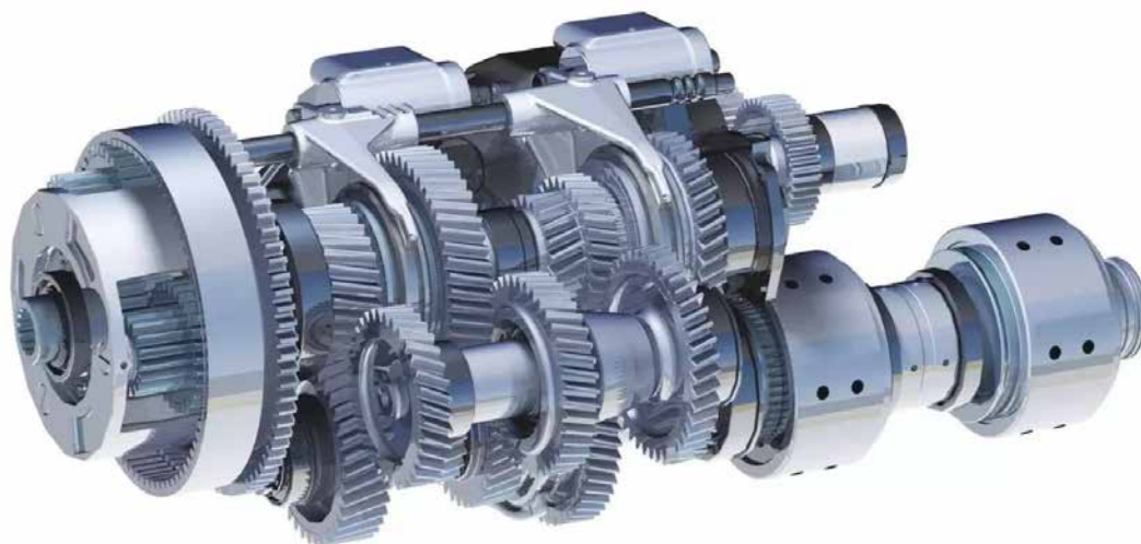
Рис. 2.7. Автоматична коробка передач (трансмісія) із технологією Powershift New Holland
