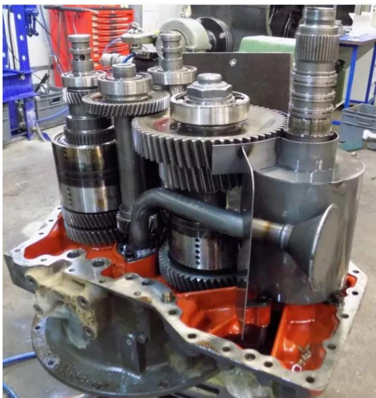
Рис. 2.7. Проведення розбирально-складальних та дефектувальних робіт КПП
