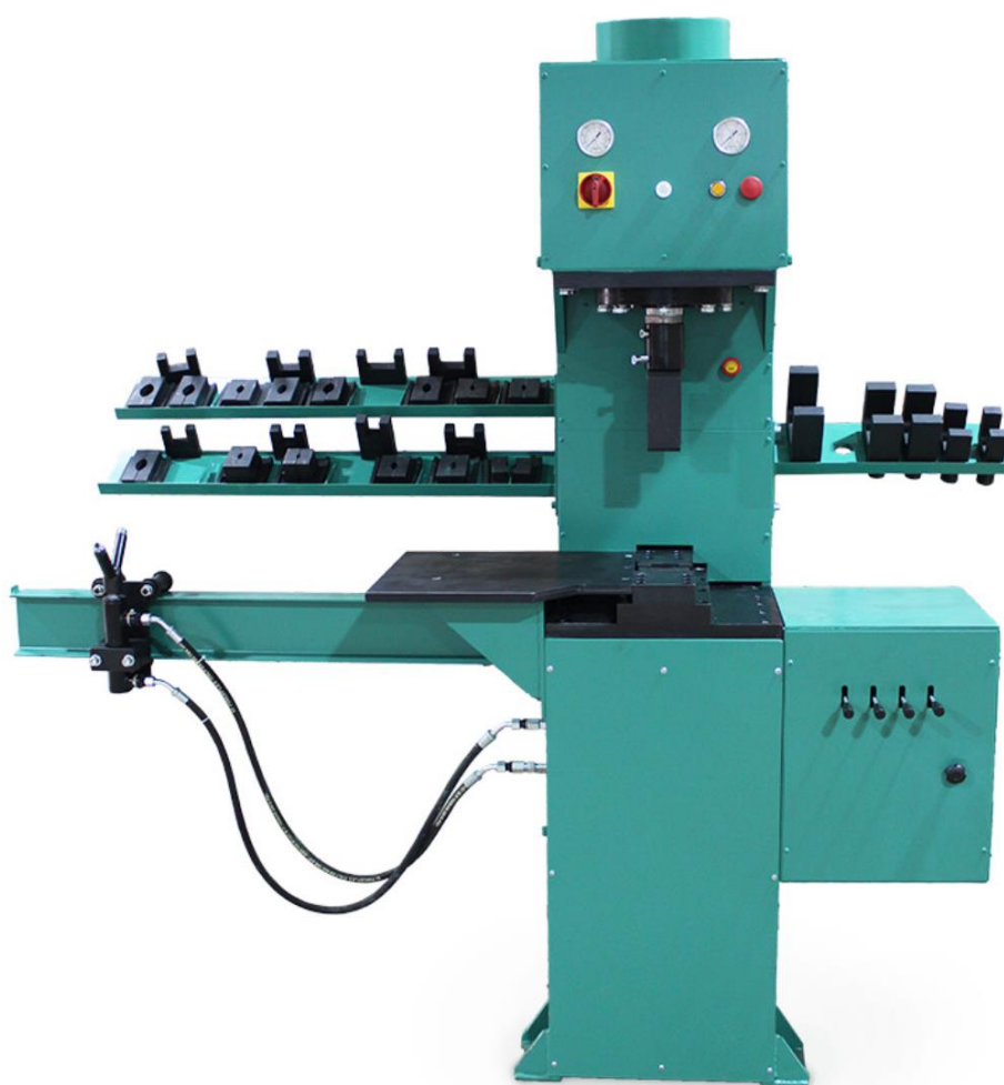
Рис. 2.2. Стенд для розбірки карданних валів П2515К
