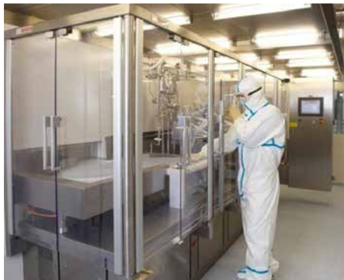
Рис. 2.5. Асептичне наповнення ін'єкційних препаратів
