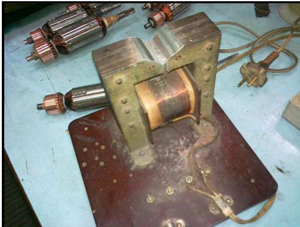
Рис 4.1. – Прилад ПУНС-5 для виявлення міжвиткових замикань та перевірки обмоток якорів і статорів електродвигунів.
