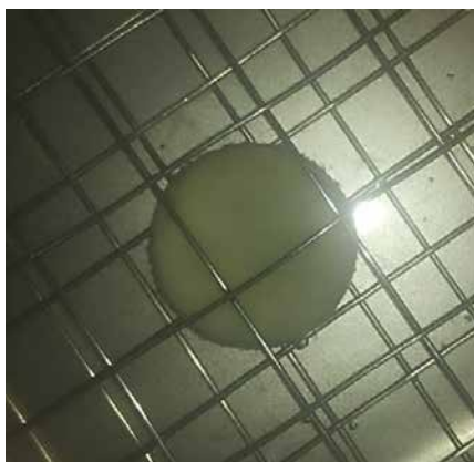
Рис. 3.13. Досліджуваний зразок, поміщений у ємність з водою УЗ ванни.
