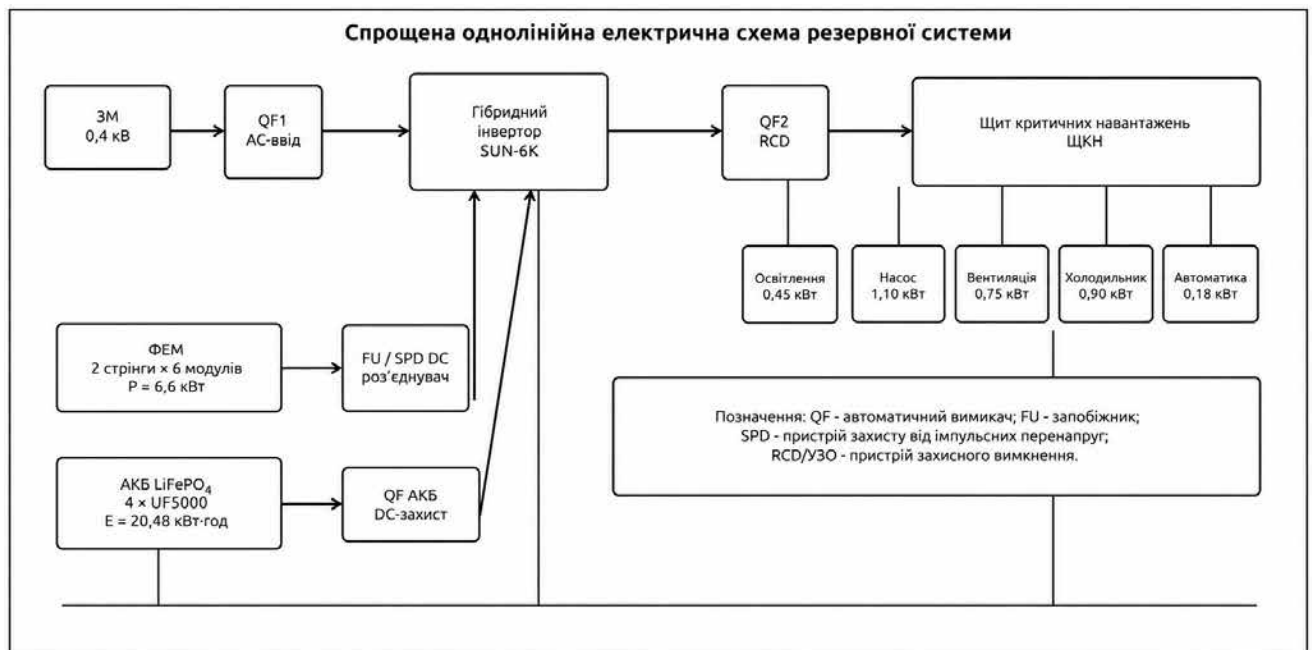
Рис. 3.2. Спрощена однолінійна електрична схема системи резервного електроживлення фермерського господарства
