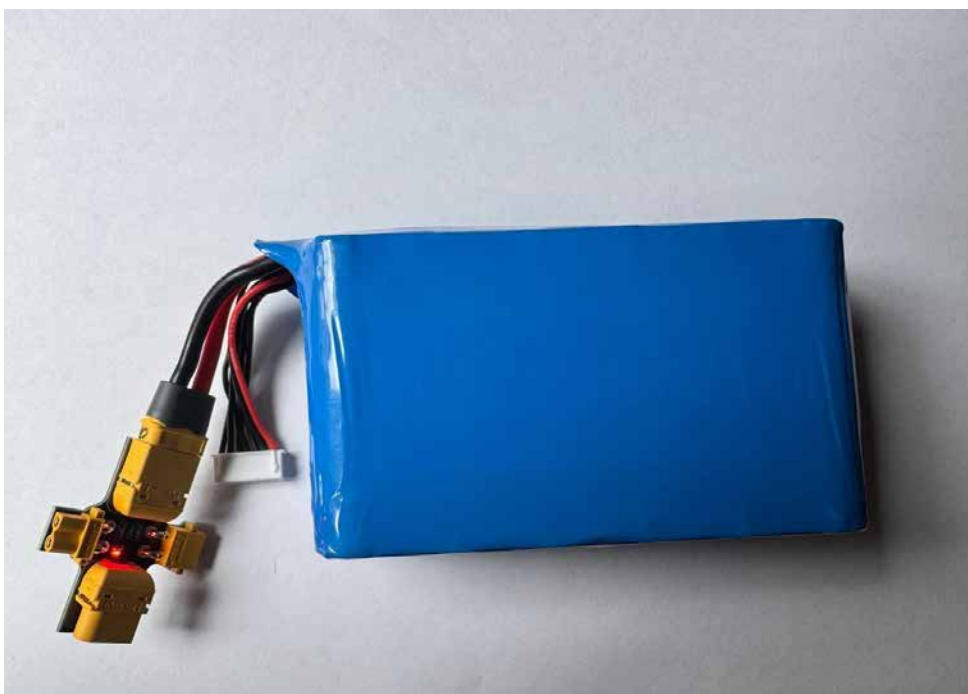
Рисунок 2.27 – батарея з “Smoke Stopper”
