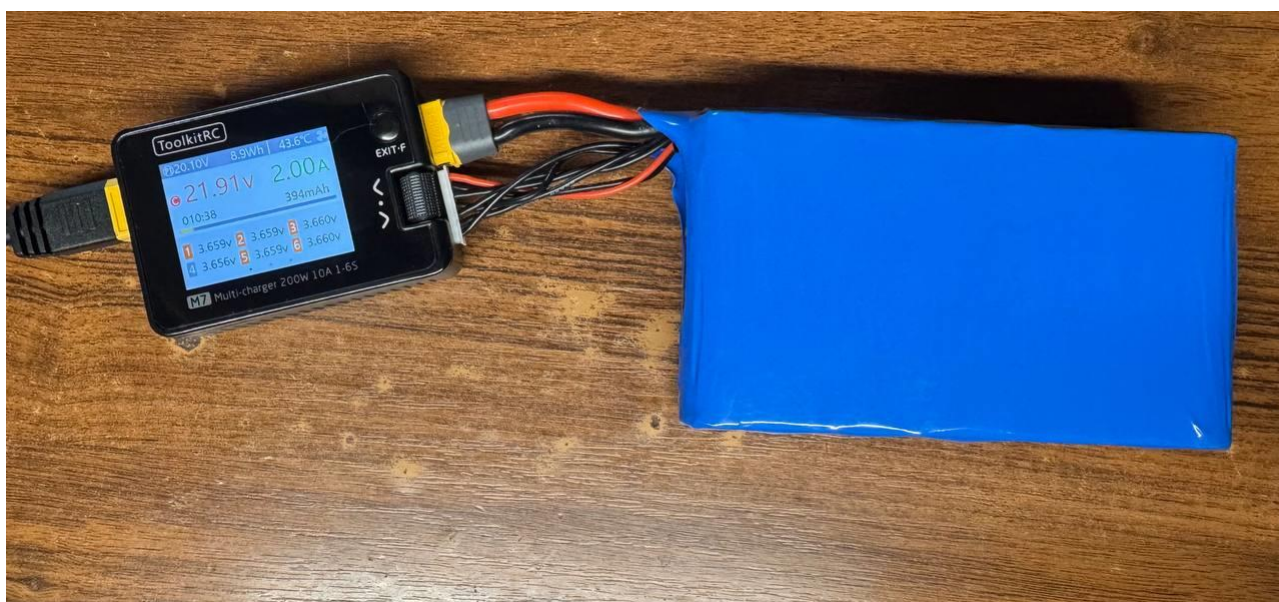
Рисунок 2.30 – Зарядження батареї пристроєм ToolkitRC M7
