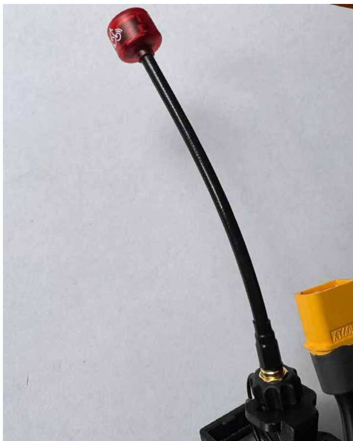
Рисунок 2.26 – Встановлена антена відеопередавача
