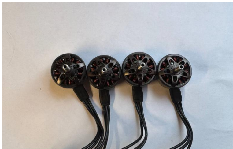
Рисунок 2.9 – Мотори EMAX ECO II 2807 1500KV
