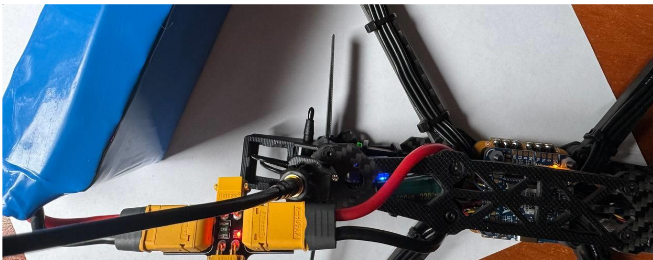
Рисунок 2.28 – Підключена батарея до дронів
