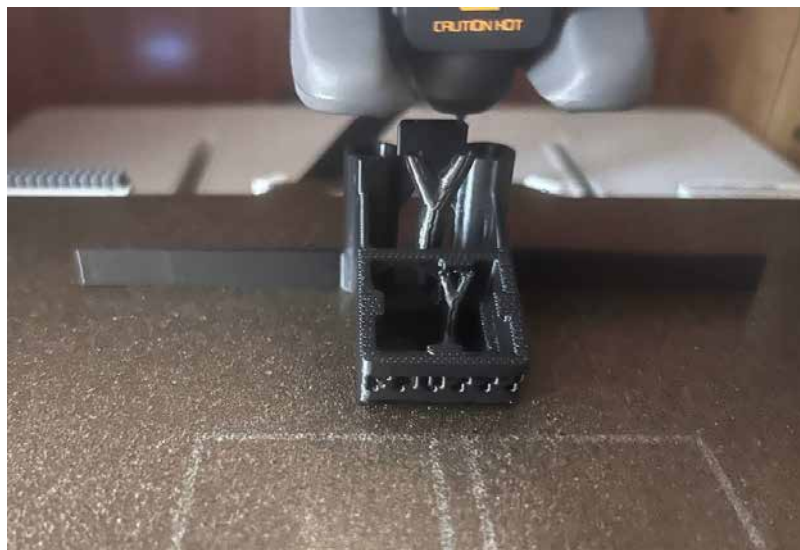
Рисунок 2.3 – Друкування тримача для антен
