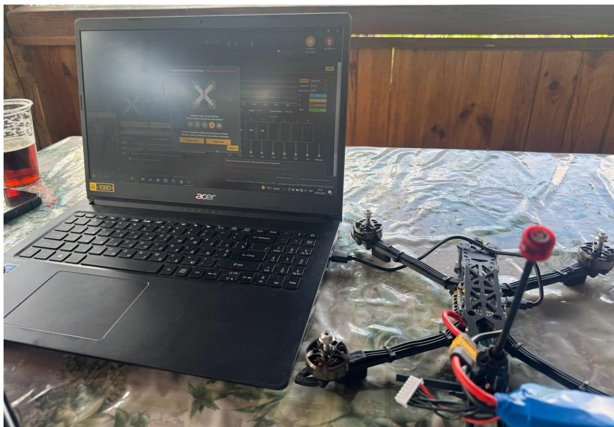
Рисунок 2.33 – Перевірка напрямку обертання моторів
