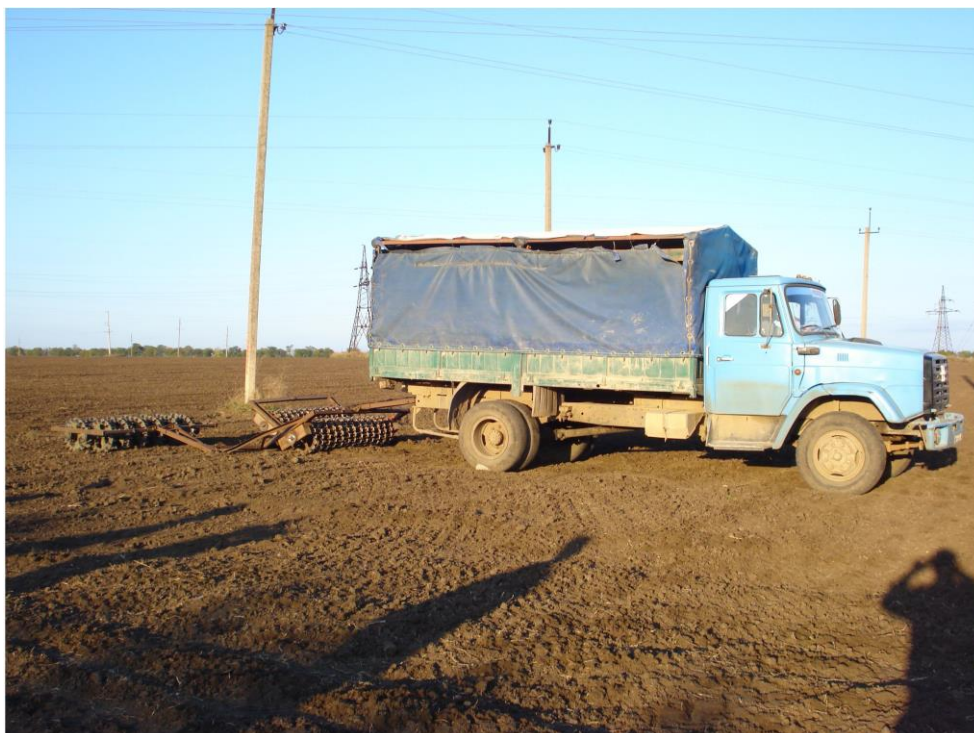
Рис.3.1 Використання автомобіля ЗІЛ–4331 з сільськогосподарською машиною ЗКШ–6 на прикочуванні
