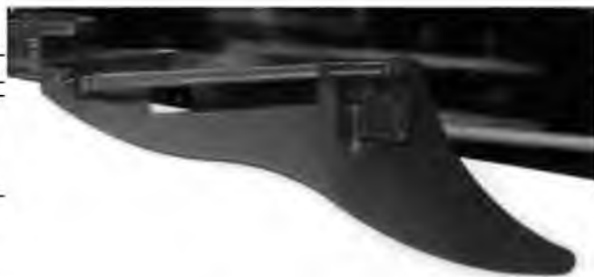
Рис. 1.12. Гребінчастий пасивний копір гичкозрізувального апарата другої групи гичкозбирального модуля бурякозбирального комбайна „Holmer” (Німеччина)
