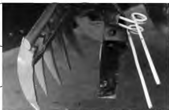
Рис. 1.10. Гребінчастий пасивний копир гичкозрізувального апарата другої групи гичкозбирального модуля бурякозбирального комбайна „Holmer” (Німеччина)
