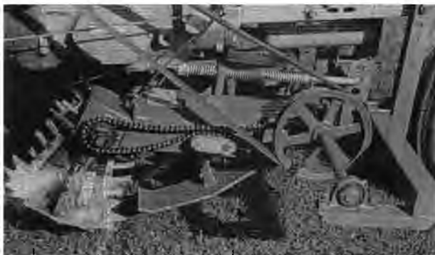
Рис. 1.6. Гичкозрізувальний апарат фірми „Fagghand” з полозовидним копіром і активним ножем
