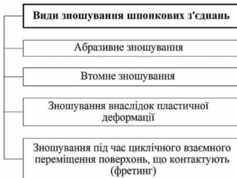
Рис. 1. Основні види зношування шпонкових з'єднань дотичних деталей машин
