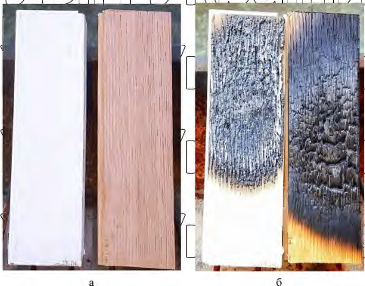
Рис. 3.4. Експериментальні зразки: а – до початку випробування; б – після випробування
