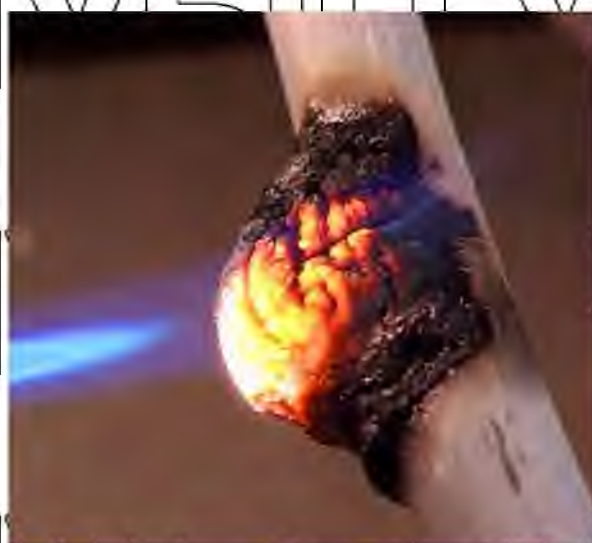
Рис. 1.1. Процес утворення пористої коксоподібної структури на поверхні деревини
