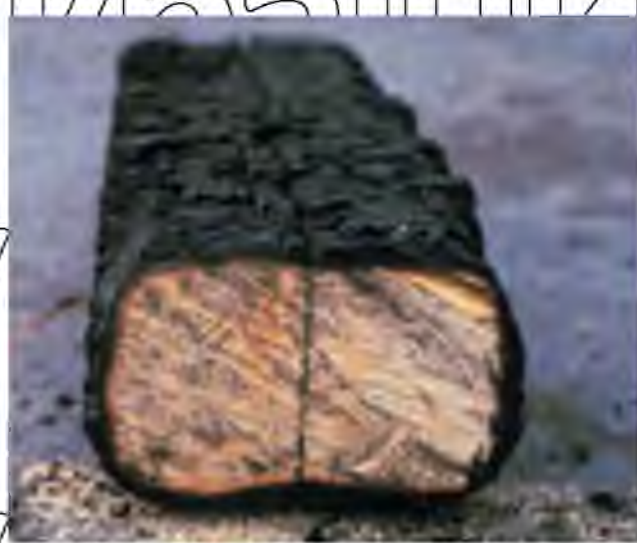
Рис. 1.1. Процес утворення пористої коксоподібної структури на поверхні деревини
