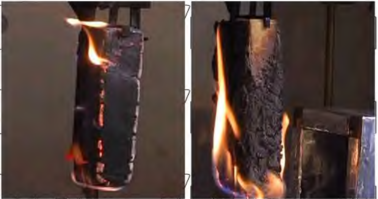
Рис. 1.3. Зразок деревини, що піддавався горінню: а – не оброблений; б – оброблений спучуючим вогнезахисним покриттям
