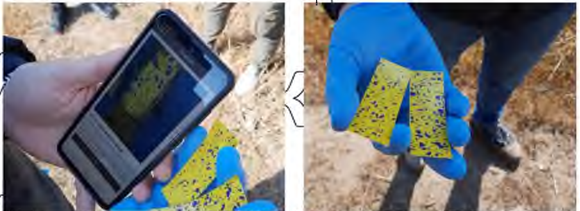
Рис. 4.20 Визначення якості покриття цільової поверхні.
