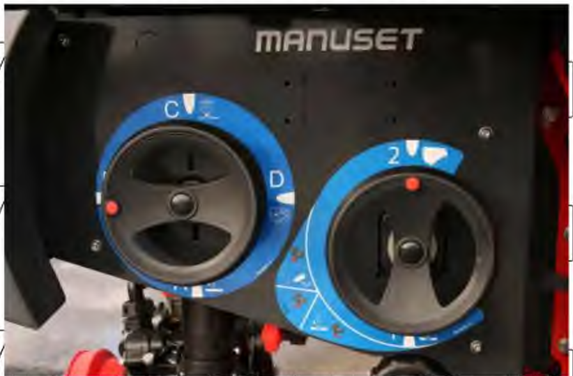
Рис. 1.3 Робоча зона управління обприскуванням MANUSET
