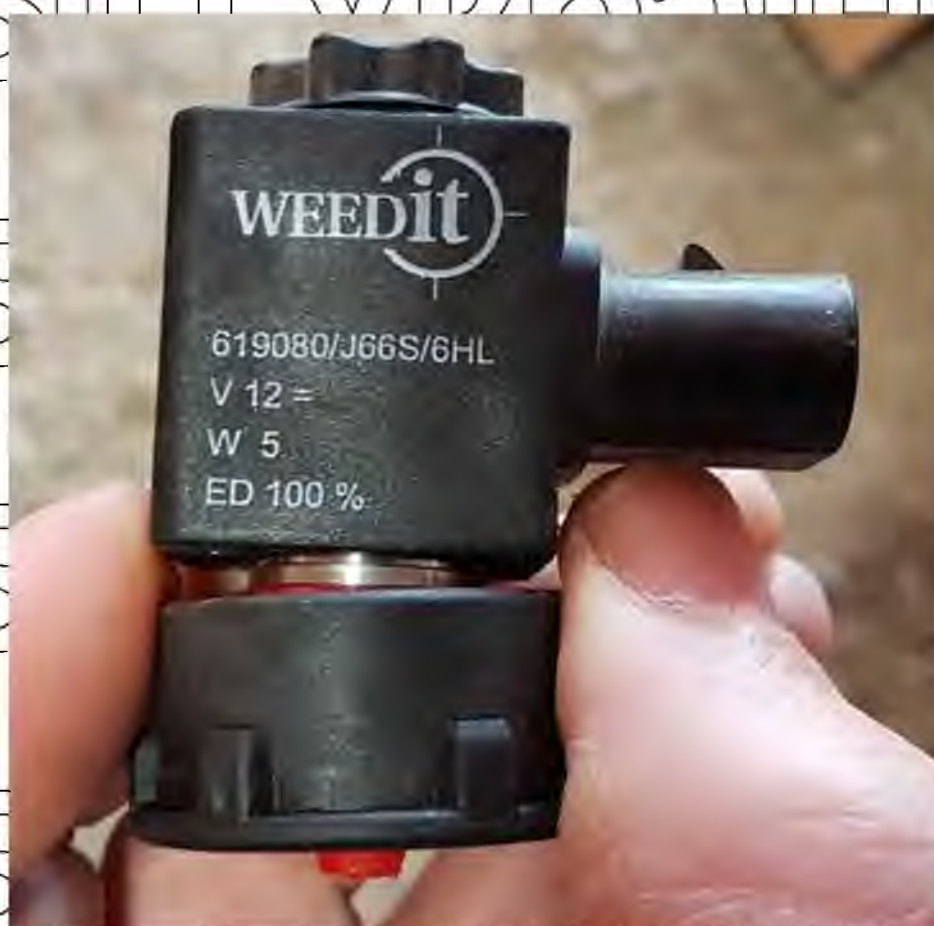
Рис. 1.23 Клапан системи ШИМ для WEEDit.
