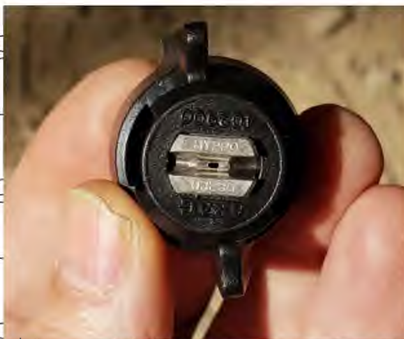
Рис. 1.19 Розпилювач Hurpo для рівномірного розпилення (смуги) з кутом відкриття факелу 30 градусів.
