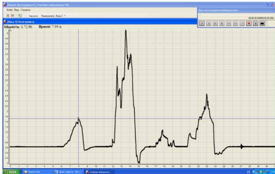
Рисунок 2. Діаграма деформації зразка ґрунту отриманий на УВКП
