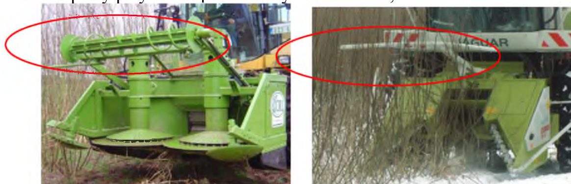
Rys. 3. Przystawki do zbioru pędów z oznaczonymi nagarniaczami: a – układ aktywny, b – układ bierny
