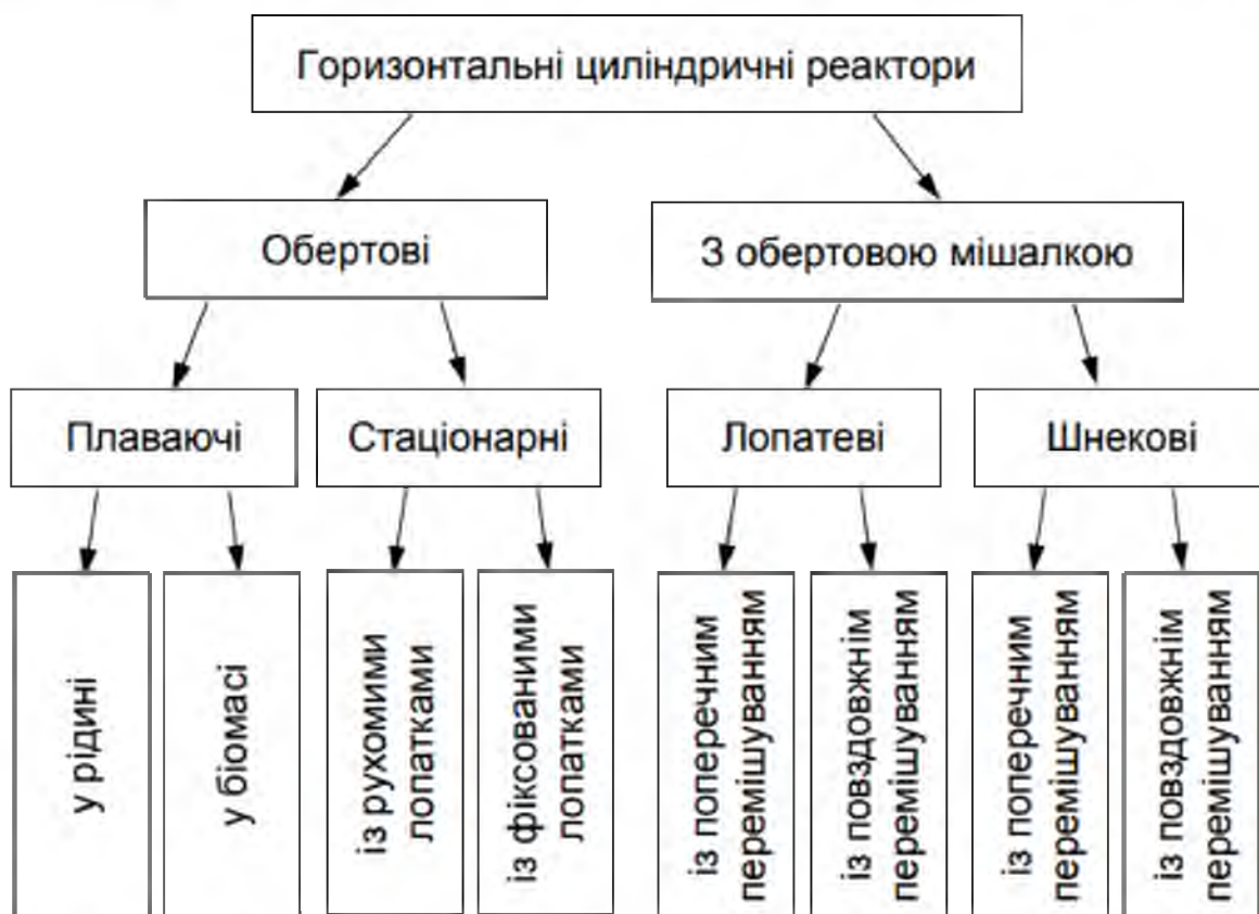
Рис. 8. Схема існуючих горизонтальних циліндричних реакторів [10]
