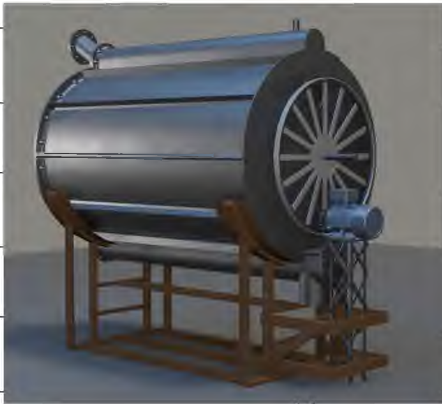
Рис. 4.1. Спроектований горизонтальний циліндричний біогазовий реактор
