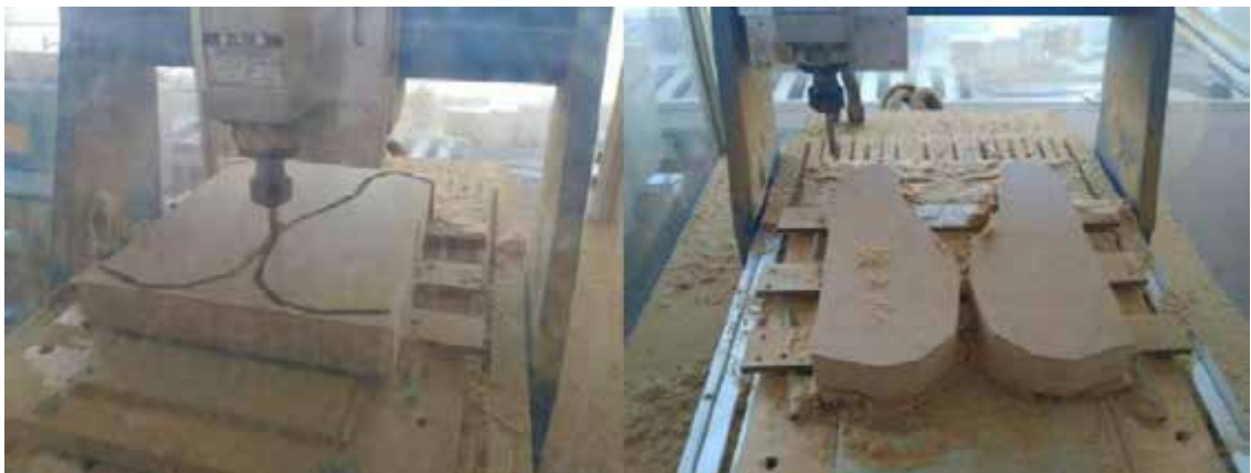
Рис. 3.3. Фрезерування форми на операції 010
