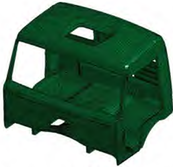
Рисунок 3.6 – Область проектування Оптимізація проводилася методом гібридних осередків (HCA) у програмі LS-TaSC, як одним з найбільш ефективним для подібних завдань
