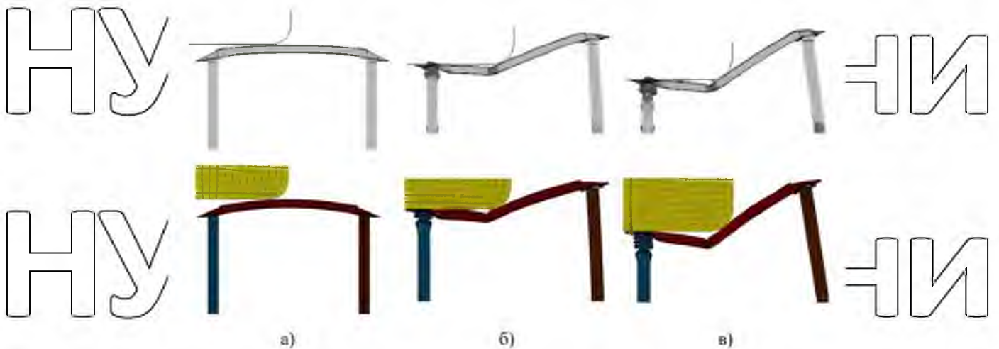
Рисунок 2.31 – Результати розрахунку бампера при часі розрахунку в 0 с (а), 0,035 с (б) та 0,075 с (в)
