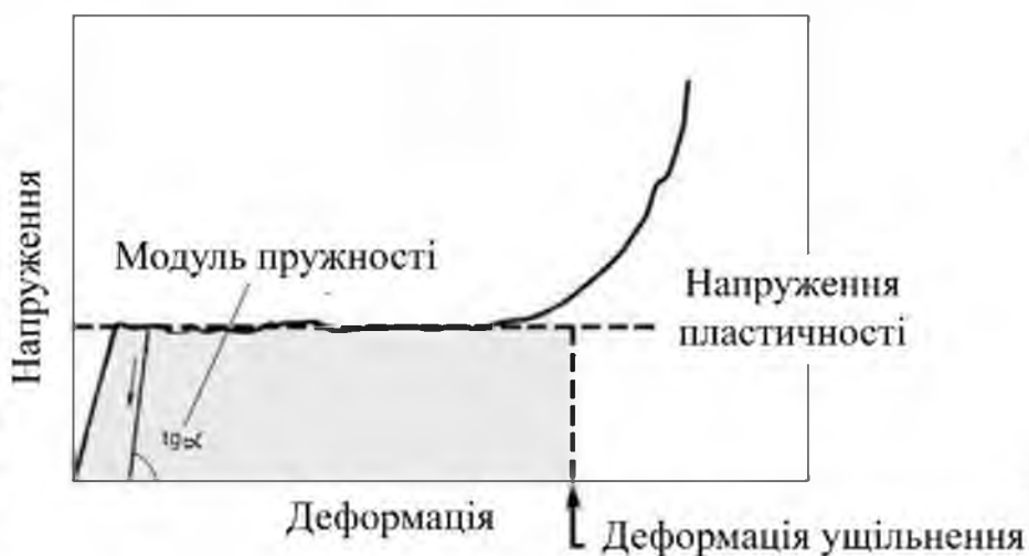
Рисунок 1.11 – Схематична крива навантаження пінометалу
