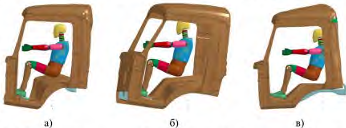
Рисунок 3.15 – Результати випробувань кабіни на передній удар (а), удар по стійці (б) та удар ззаду (в)
