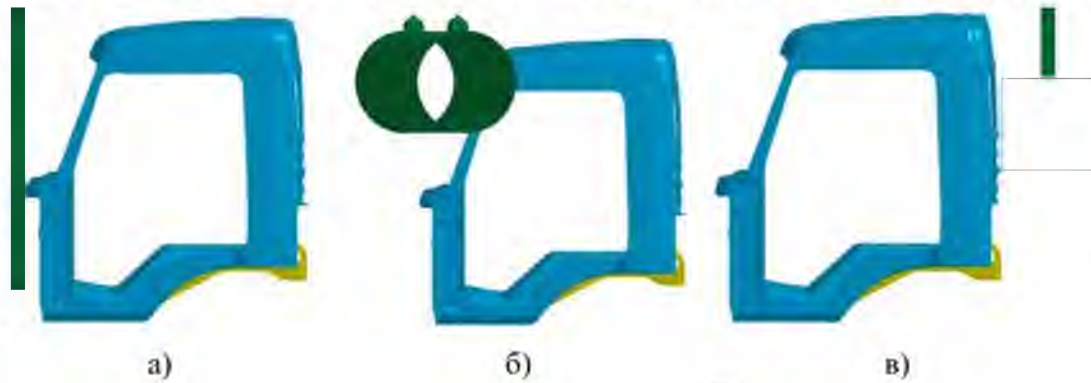
Рисунок 3.2 – Види випробувань кабіни на передній удар (а), удар по стійці (б) та удар задю (в)
