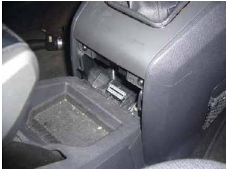
Рис. 3.11. Діагностичний роз'єм Opel Zafira B [13]
