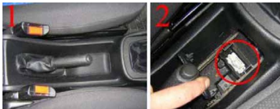
Рис. 3.10. Діагностичний роз'єм Opel Zafira B
