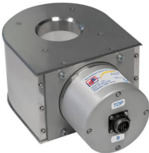
Рис. 3.3 Мікрохвильовий вологомір вермикуліту PCE-A-315
