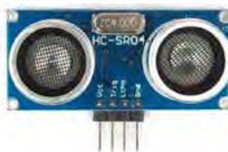
Рисунок 3.11 Ультразвуковий датчик
