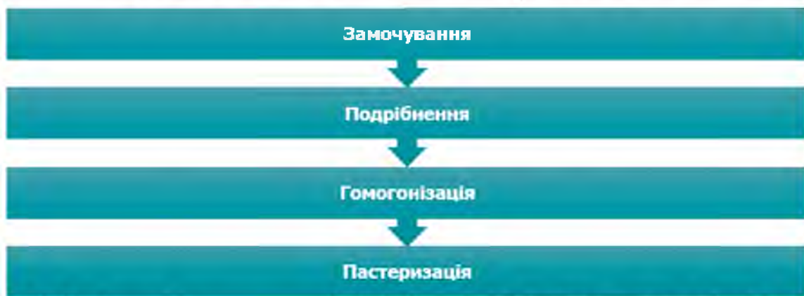
Рис. 1.8. Схема технологічного процесу отримання рослинного молока [23].
