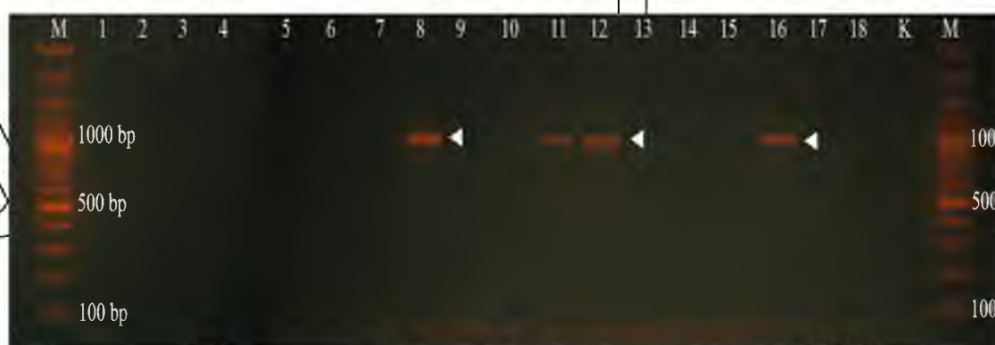
Рис. 3.1. Ампліфікація ділянки гену аеролізіну aerA бактерій роду Aeromonas виділених з коропа та товстолюба: 1-18 – зразки ДНК виділених бактерій, К – контроль, М – ДНК-маркер.
