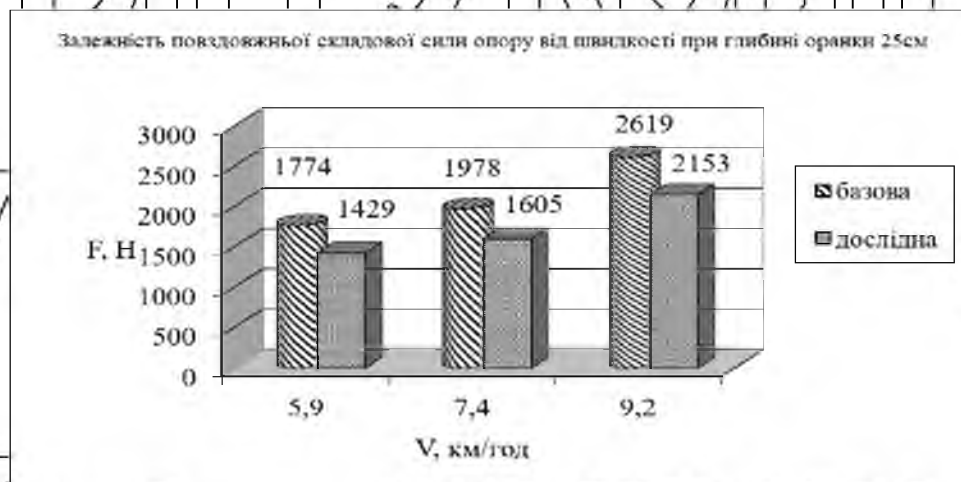
Рис. 3.3 Залежність поєздовжньої складової сили опору від швидкості при глибині оранки 25см.
