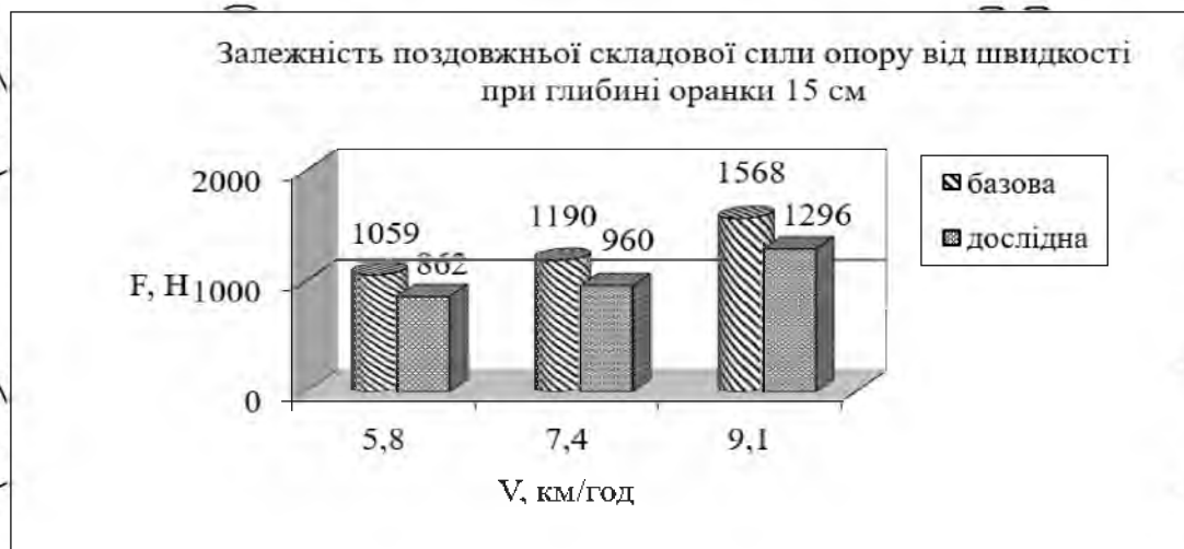
Рис. 3.1 Залежність поздовжньої складової сили опору від швидкості при глибині оранки 15 см.
