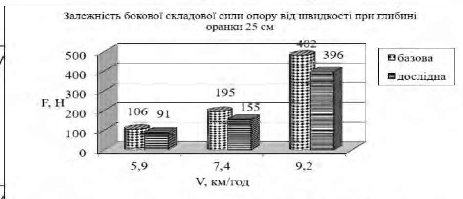
Рис. 3.6 Залежність бокової складової сили опору від швидкості на глибині оранки 25 см.
