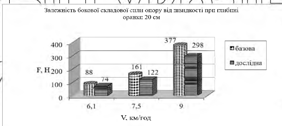
Рис. 3.5 Залежність бокової складової сили опору від швидкості на глибині оранки 20 см.
