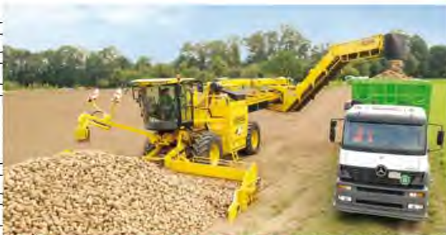
Рис. 2.3. Навантаження цукрових буряків очищувачем-навантажувачем Ерго-Маус3 (РОРА).
