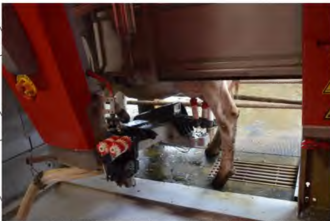
Рис. 3.1.6. Фрагмент доїння корови у фазу надівання доїльних стаканів на дійки (VMS Lely Astronaut A-5).
