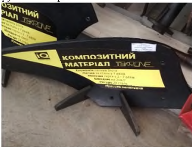
Рис. 1. Відвал плуга, виготовлений з високомолекулярної сполуки “TEKRONE”
