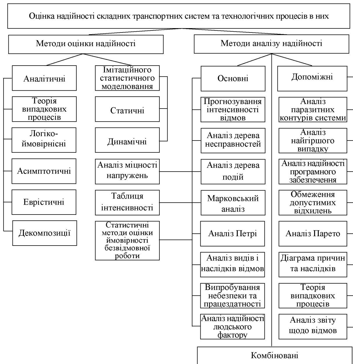
Рис. 1. Класифікація методів оцінки надійності складних транспортних систем і технологічних процесів в них.
