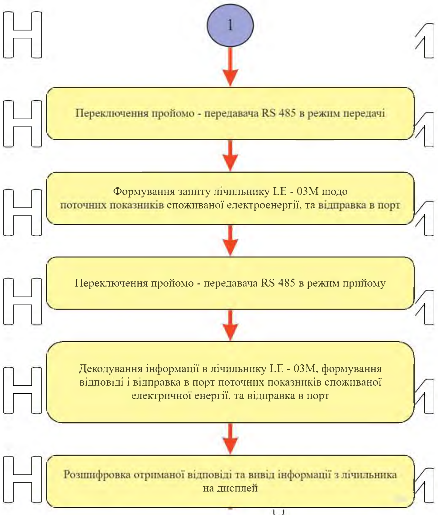
Рис 3.4.4 Блок схема для ілюстрації описаного вище алгоритму функціонування системи а саме отримання даних від лічильника.
