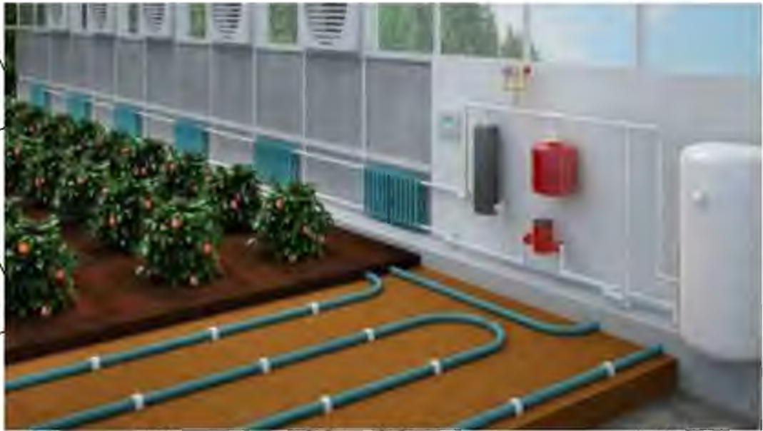
Рис. 1.3 – Схема трубного опалення теплиці
