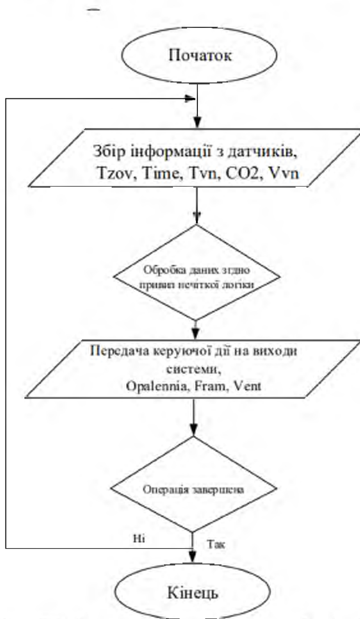
Рисунок 3.2 Алгоритмічна схема система прийняття рішень
