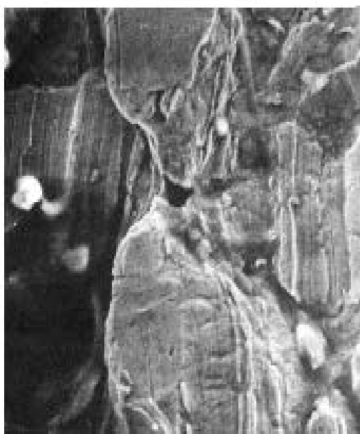
Рис. 3. Момент початку формування макротріщини.
