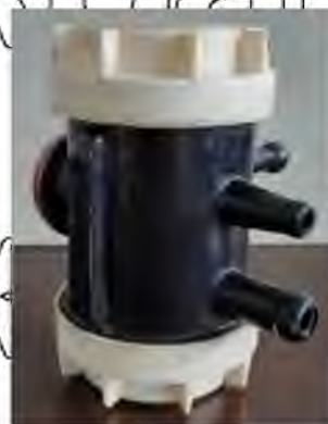
Рис. 3.1. Схема розробленого блока пульсаторів доїльного апарата та загальний вигляд: 1, 4 - камери постійного вакуумметричного тиску; 2 - підвідний вакуумний патрубок; 3 - камера постійного атмосферного тиску; 5, 12 - мембрана; 6, 11 - дросельні отвори; 7, 10 - керований канал; 8 - вивідні патрубки керованого тиску; 9 - блоки клапанів управління.
