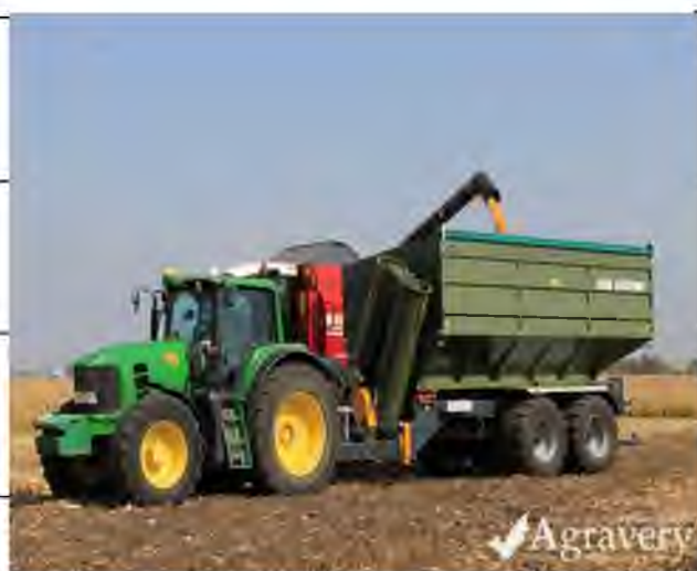
Рис. 2.2. Причіп-перевантажувач спеціалізований в агрегаті з трактором
