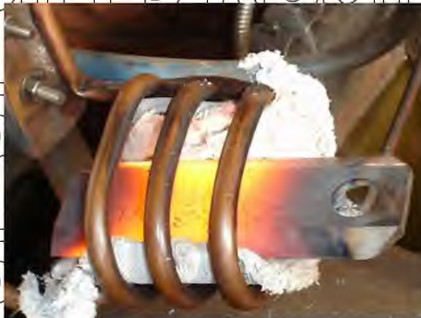
Рис.3.13. Приклад загартування ножа кормоподрібнювача .
