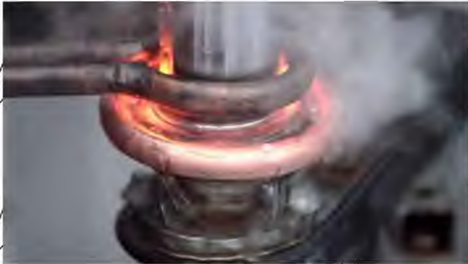
Рис. 3.14. Приклад поверхневого загартування валу щнека кормоподрібнювача
