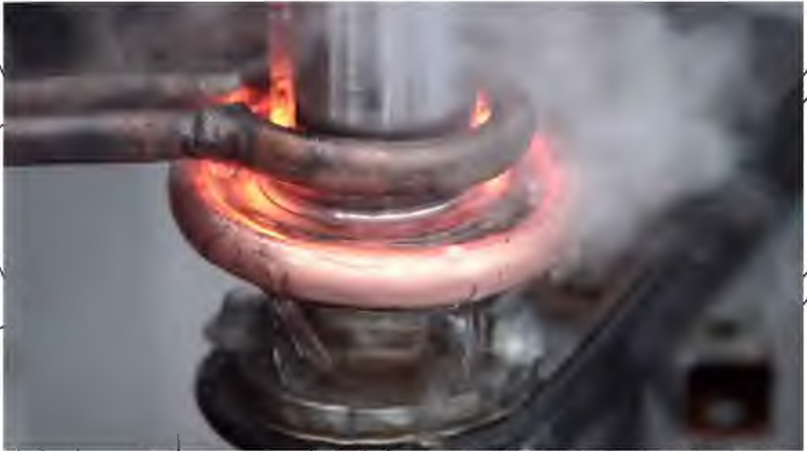
Рис 3.1 Зображення установки ТВЧ в роботі.
