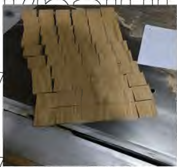
Рис. 3.2. Підготовка зразків до випробування: а – технологічне витримування; б, в – розкрій на зразки відповідного розміру.
