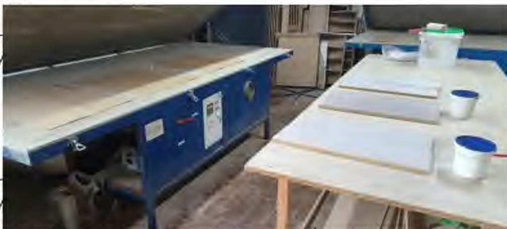
Рис. 3.1. Личкування зразків у вакуумному пресі
