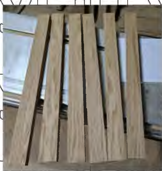
Рис. 3.2. Підготовка зразків до випробування: а – технологічне витримування; б, в – розкрій на зразки відповідного розміру.
