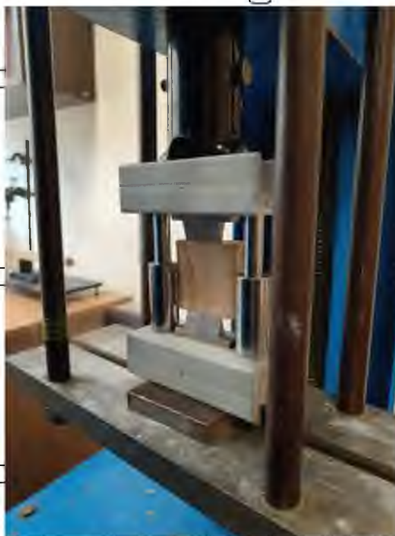
Рис. 3.4. Зразок закріплений в розривній машині до проведення дослідів
