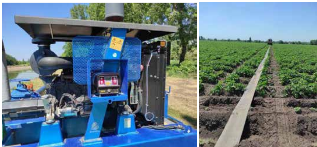
Рис 2.3.4 Насосна станція Casella та магістральна поливна стрічка Heliflex Monoflat 6" с. Городище Київської області
