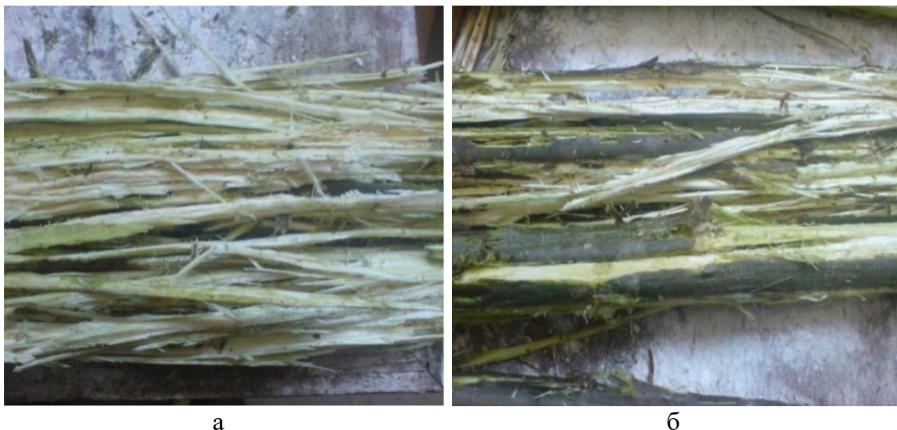
Рис. 5. Плетиво волокон, отримане після роздавлювання: а – середня товщина елементів плетив 1–5 мм, б – середня товщина елементів плетив 6–10 мм.
