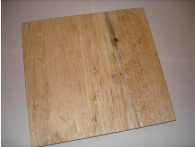
Рис. 6. Деревинно-композиційний матеріал на основі карбомідоформальдегідної смоли
