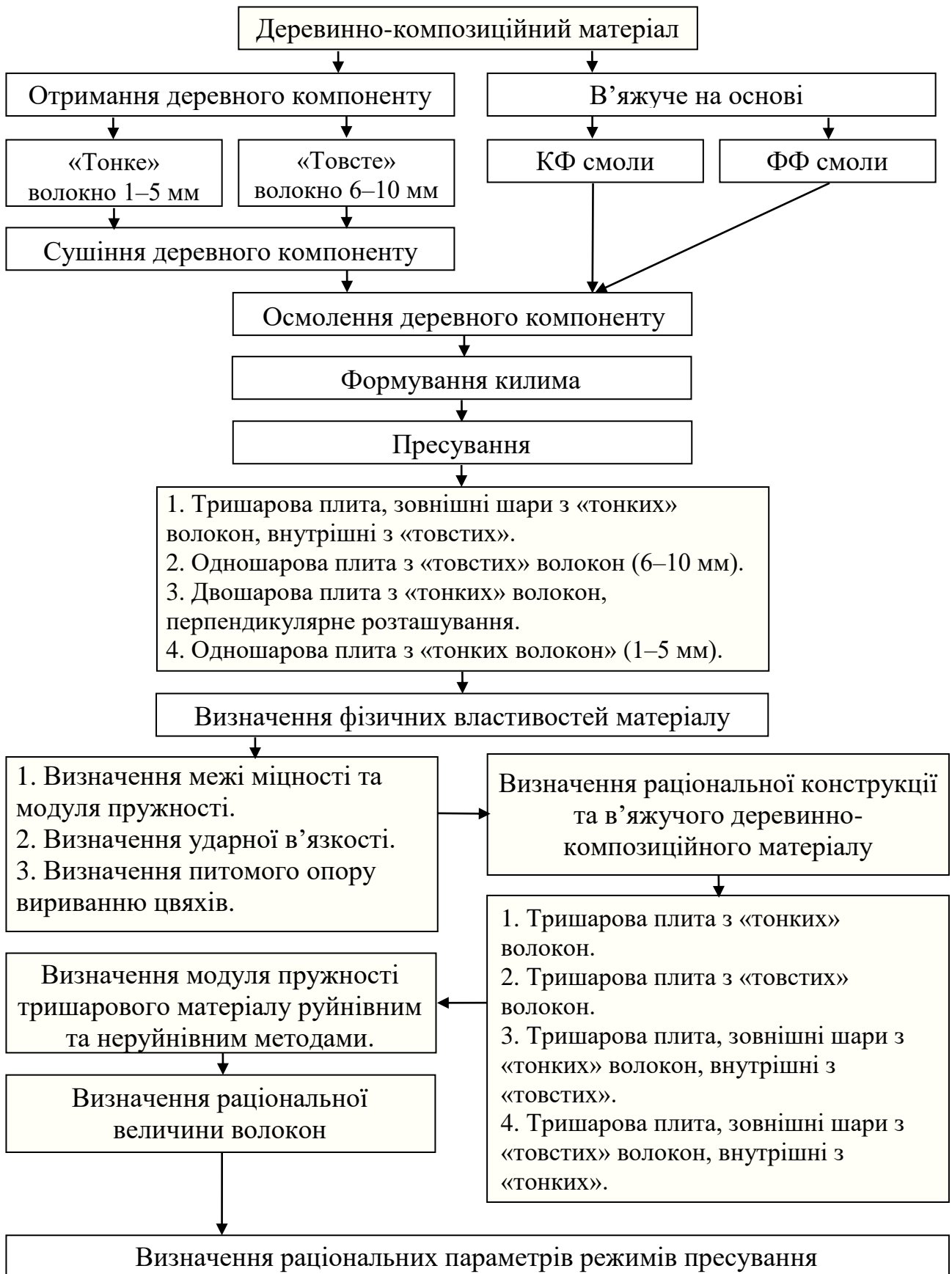
Рис. 3. Блок-схема методичних принципів проведення експериментальних досліджень
