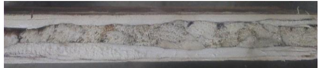
Рис. 9. Тришаровий деревинно-композиційний матеріал, з перпендикулярним розташуванням волокон
