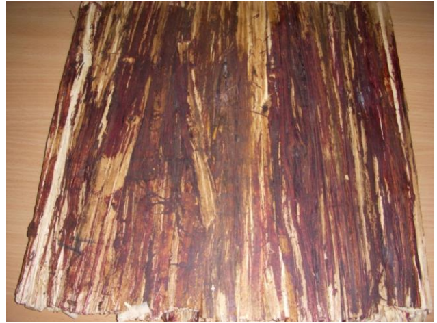
Рис. 7. Деревинно-композиційний матеріал на основі фенолформальдегідної смоли
