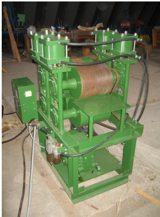
Рис. 4. Експериментальна установка для роздавлювання тонкоміру
