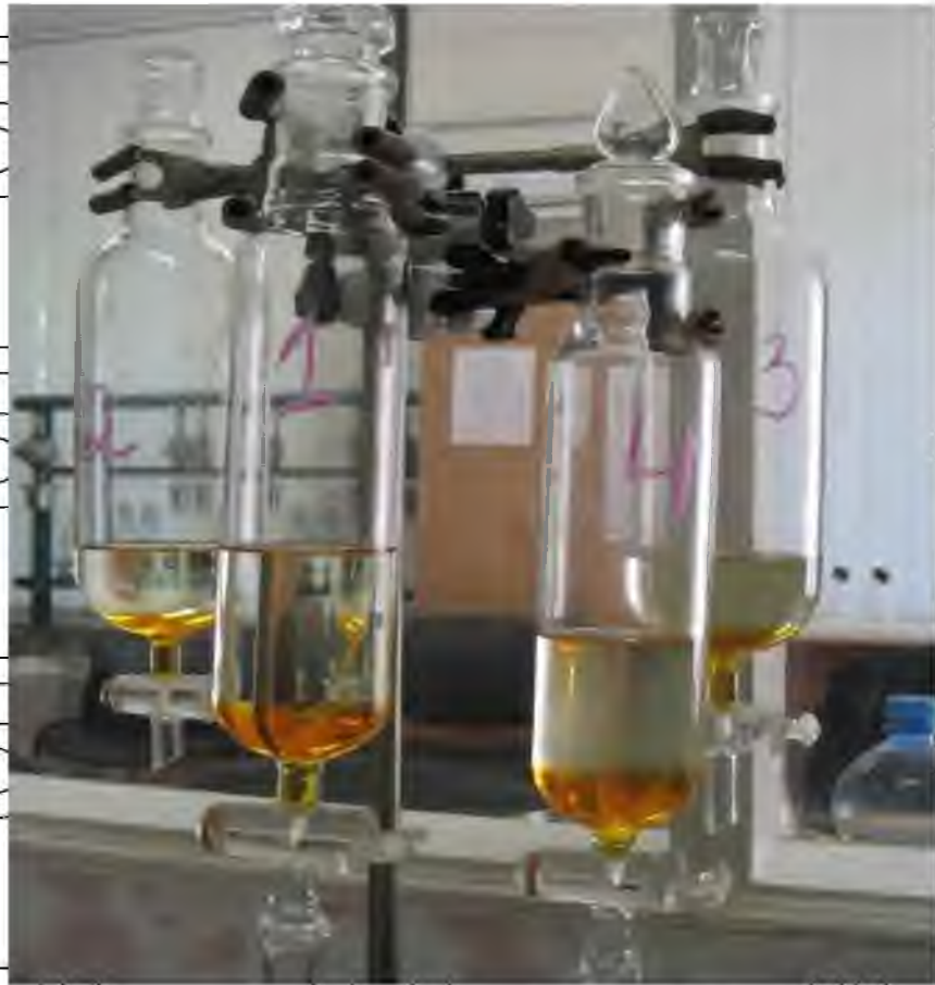
Рис. 3.2. Процес седиментації суміші на гліцерині і метиловий ефір
