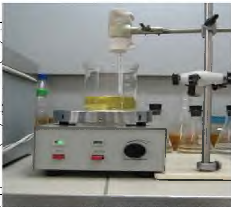
Рис. 3.1. Процес виробництва метилового ефіру шляхом естерифікації соняшникової олії із каталізатором
