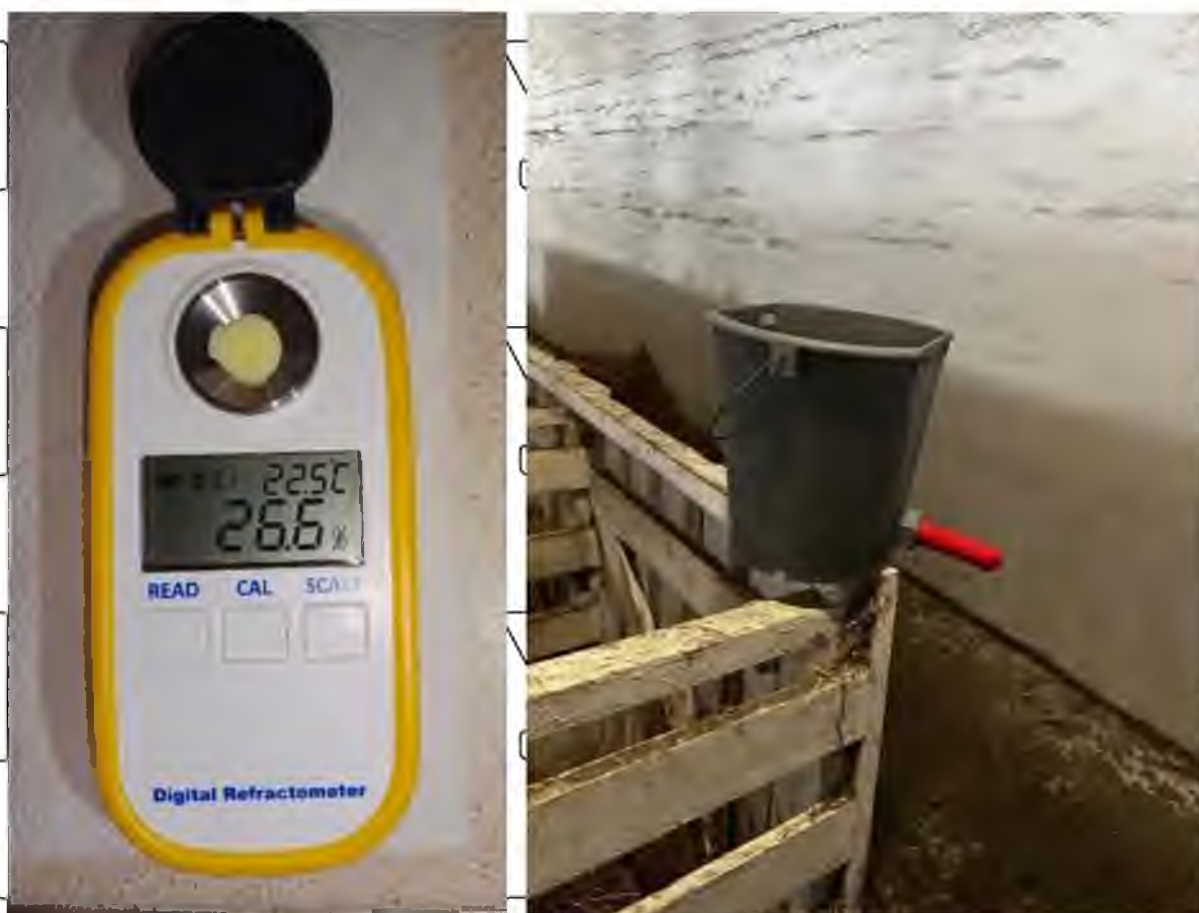
Рис. 3.3 – Якість молзсизва рефрактометром (а) і відро для молочних кормів з соскою (б).
