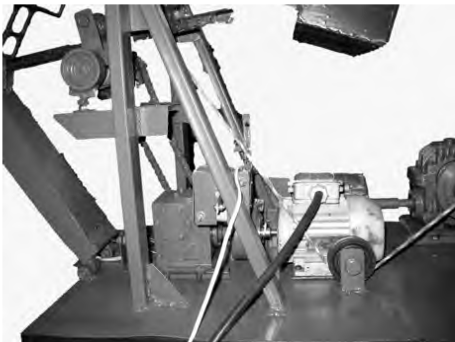
Рис. 3.3. Загальний вигляд механізму зміни вильоту стрілової системи
