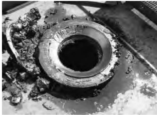
Рис. 1.18. Аварія портального крана «Азовмаш»: а) зруйнований опорний вузол поворотної колони; б) викришений упорно-радіальний підшипник.
