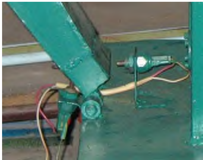
Рис. 3.4. Кінцеві вимикачі механізму зміни вильоту
