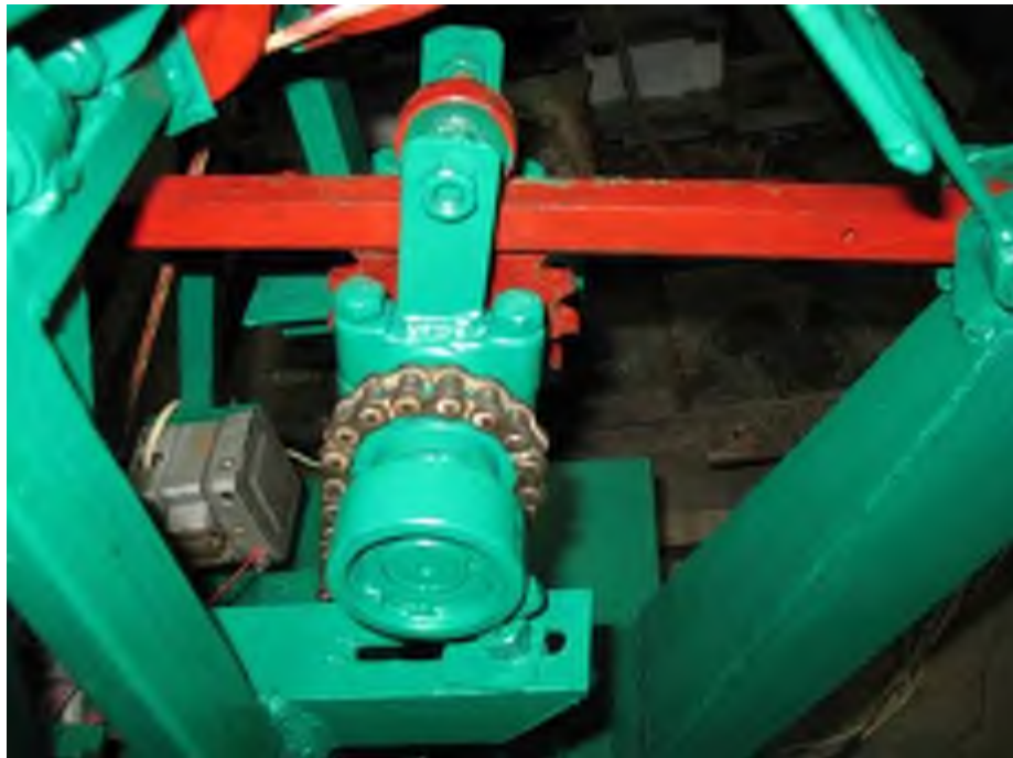
Рис. 3.2. Зубчасте колесо приводу із зубчастою рейкою
