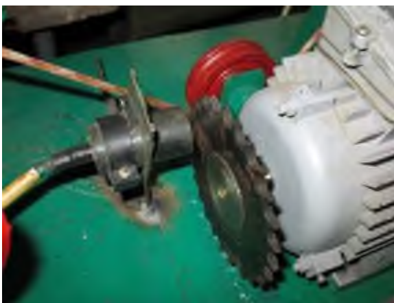
Рис. 3.17. Електродвигун із зірчкою та датчиком ДЧВ-1
