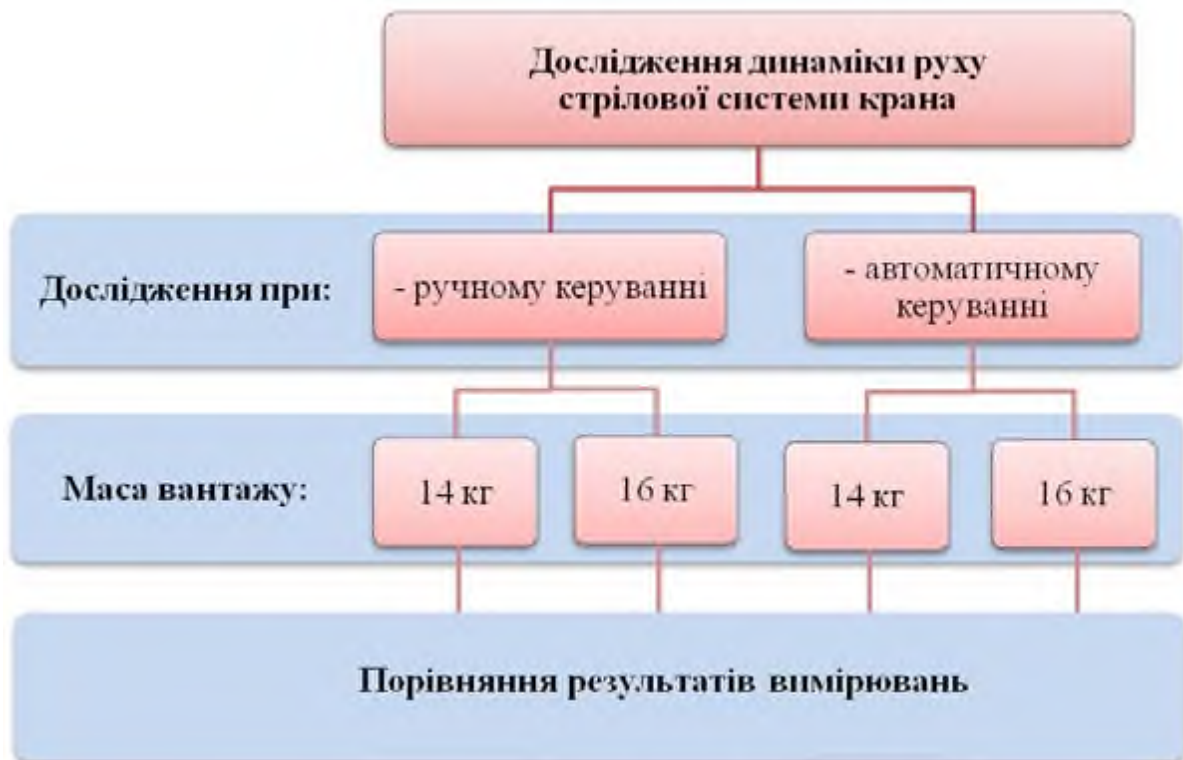
Рис. 3.21. Схема проведення досліджень динаміки руху шарнірно-зчленованої стрілової системи крана
