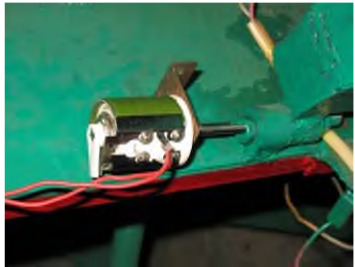
Рис. 3.10. Датчик кута нахилу стріли до горизонту
