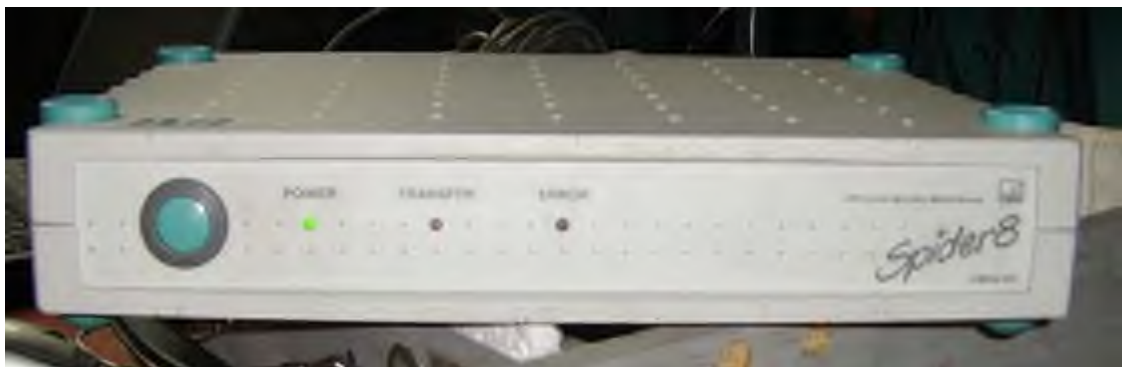
Рис. 3.19. Аналогово-цифровий перетворювач Spider-8
