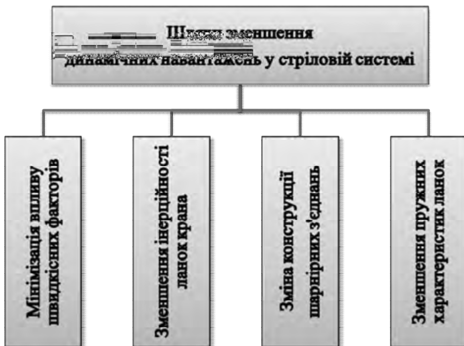
Рис. 1.20. Шляхи зменшення динамічних навантажень у шарнірно-зчленованій стріловій системі крана.
