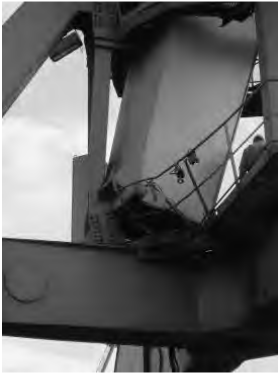
Рис. 1.18. Аварія портального крана «Азовмаш»: а) зруйнований опорний вузол поворотної колони; б) викришений упорно-радіальний підшипник.
