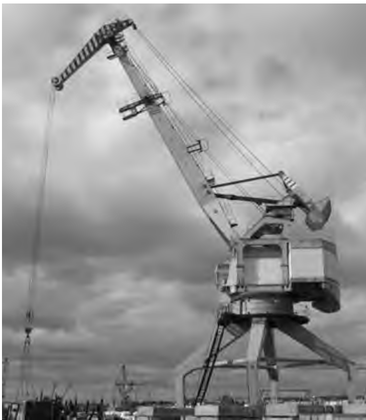
Рис. 1.4. Кран з шарнірно-зчленованою стріловою системою із гнучкою відтяжкою: а) при навантаженні будівельних конструкцій; б) схема стрілової системи.
