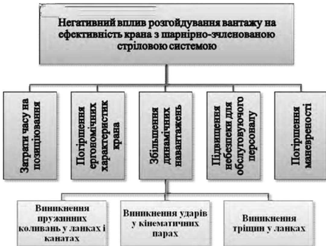
Рис. 1.15. Фактори негативного впливу розгойдування вантажу на ефективність крана із шарнірно-зчленованою стріловою системою.
