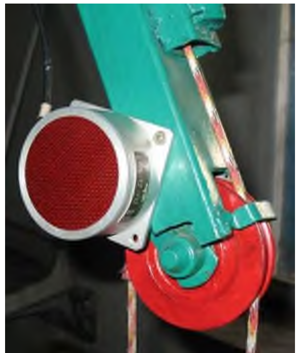
Рис. 3.9. Датчик кута відхилення вантажного канату
