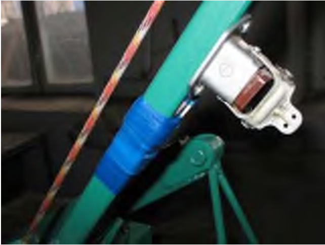
Рис. 3.15. Відтяжка підготовлена до проведення досліджень
