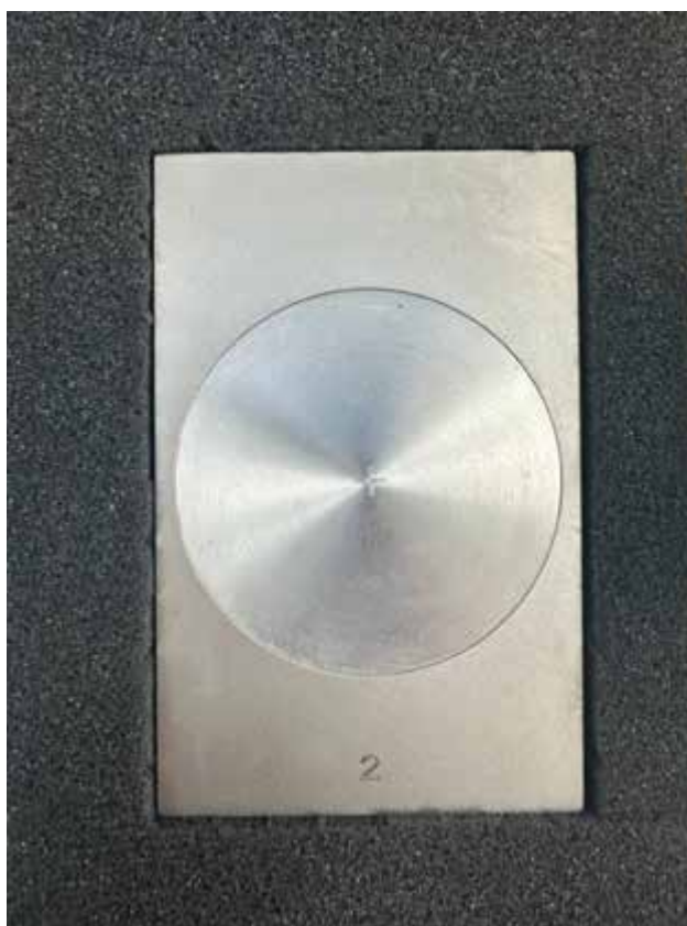
Рис 3.1. Фільтр 2 радіометра РКС-01
