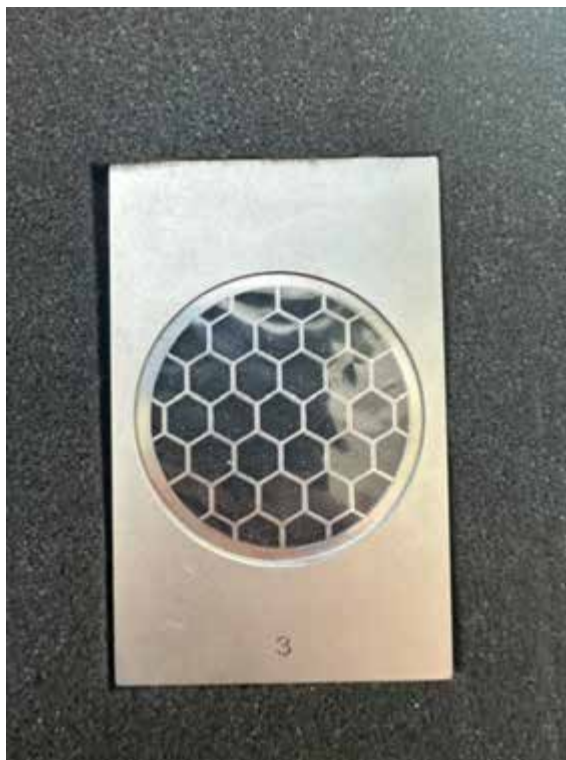
Рис 3.2. Фільтр 3 радіометра РКС-01
