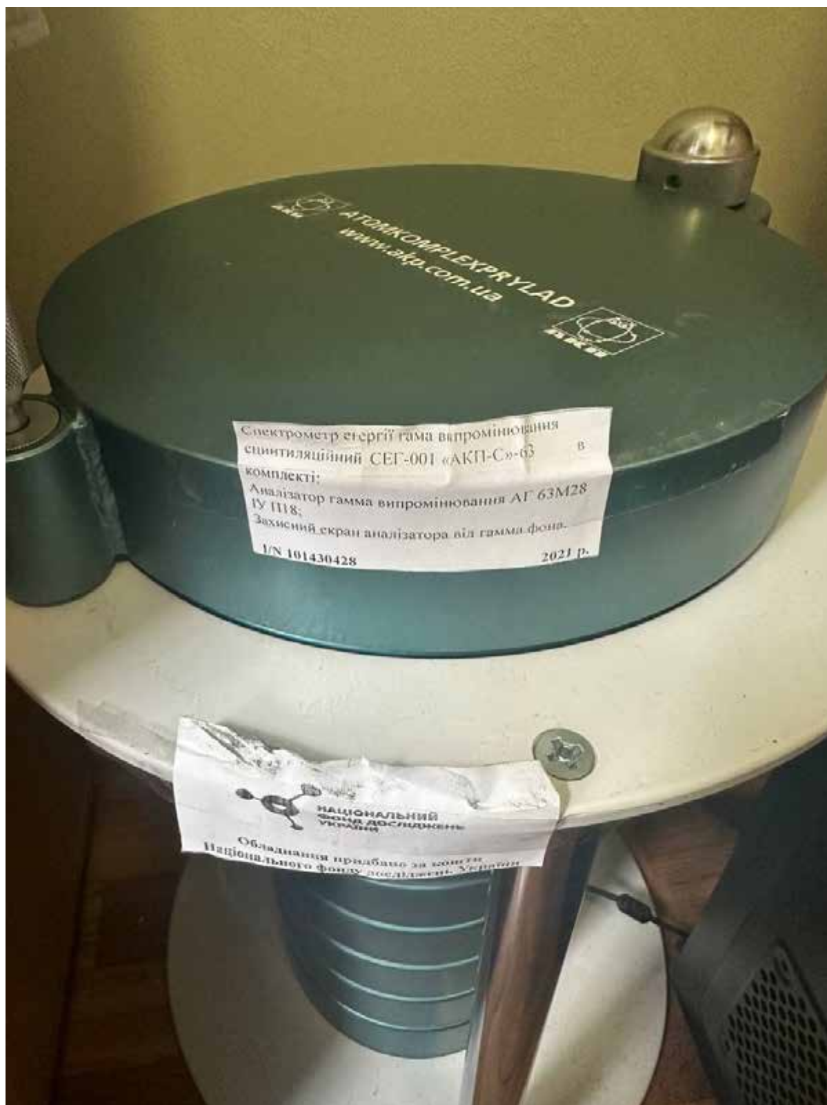
Рис. 3.14. Спектрометр енергії гама випромінювання сцинтиляційний СЕГ-001 «АКП-С»-63
