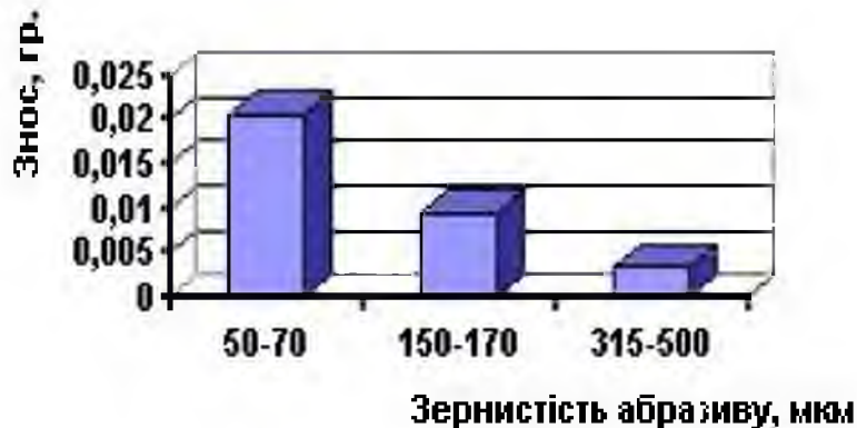
Рис. 4. Залежність зношування дискретних поверхонь в умовах абразивного зношування від зернистості абразиву [5].
