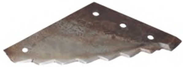
Рис 1. Ніж сегментний змішувача-кормороздавача модельного ряду «Verti Mix» (зношеного).
