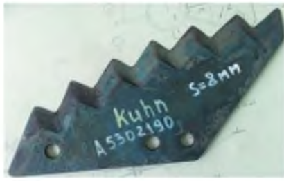
Рис 1. Ніж сегментний змішувача-кормороздавача модельного ряду «Verti Mix» (зношеного).
