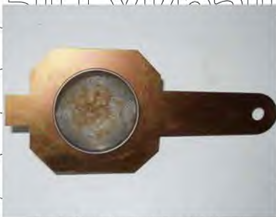
Рис. 6 Сито з діаметром вічок 200-300 мкм
