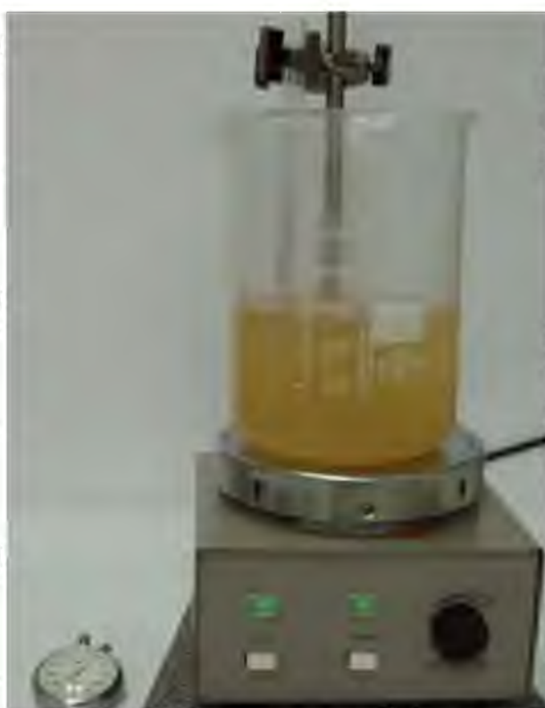
Рис. 5 Магнітна мішалка MM-5
