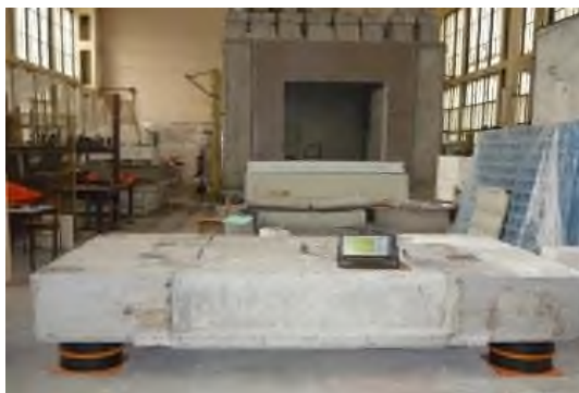
Рисунок 2 – Динамічні випробовування системи сейсмоізоляції (визначення фактичної жорсткості та демпфування гумових сейсмоопор) [2]
