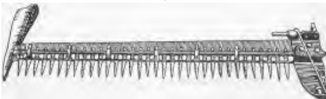
Рис. 7. 53. Пальцьові бруси з пальцями різальних апаратів різання: а – нормального; б – низького; в – середнього
