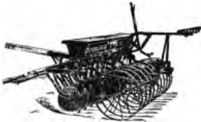
Рис. 5. 19. Пресова сівалка Демстера з дисковими сошниками
