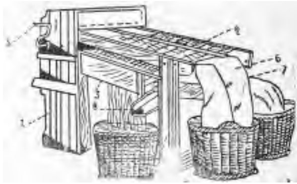
Рис. 9. 12. Картопляна сортувалка Дрейера з горизонтальними дротяними решетами
