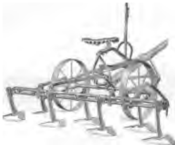
Рис. 3. 27. Культиватор для суцільного обробітку ґрунту з стрічастими лапами заводу Парлинь и Орендорфъ
