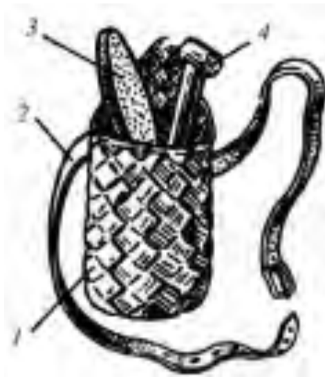
Рис. 7. 13. Пристрій для інструментів: 1 – футлярчик; 2 – пасок; 3 – брусок; 4 – гладенький точильний стержень
