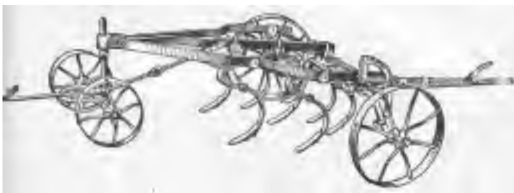
Рис. 3. 28. Культиватор кінний без сидіння ПСЧ 9 (СРСР, 30-ті роки ХХ ст.) для суцільного обробітку ґрунту з розпушувальними лапами на пружинних стояках
