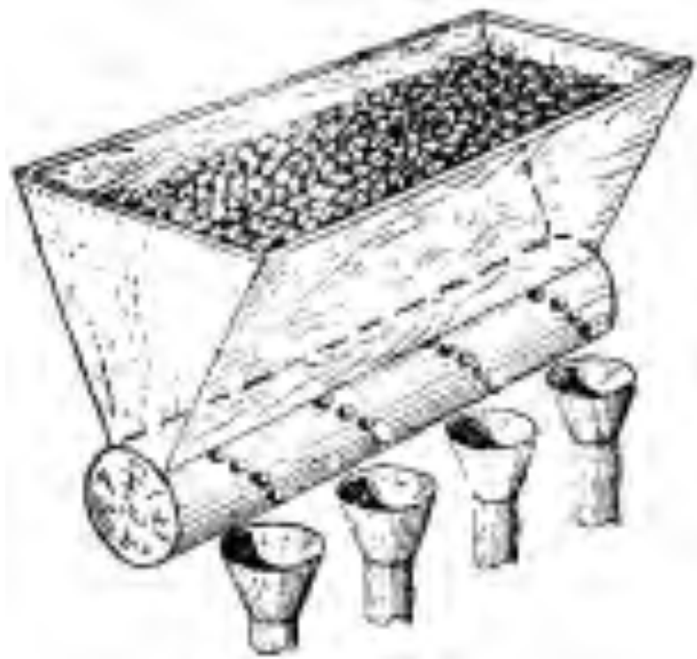
Рис. 5. 13. Схема висівного апарата сівалки Дукета
