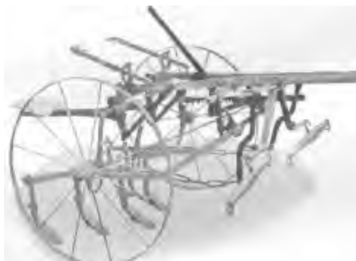
Рис. 3. 31. Кінний культиватор для міжрядного обробітку
