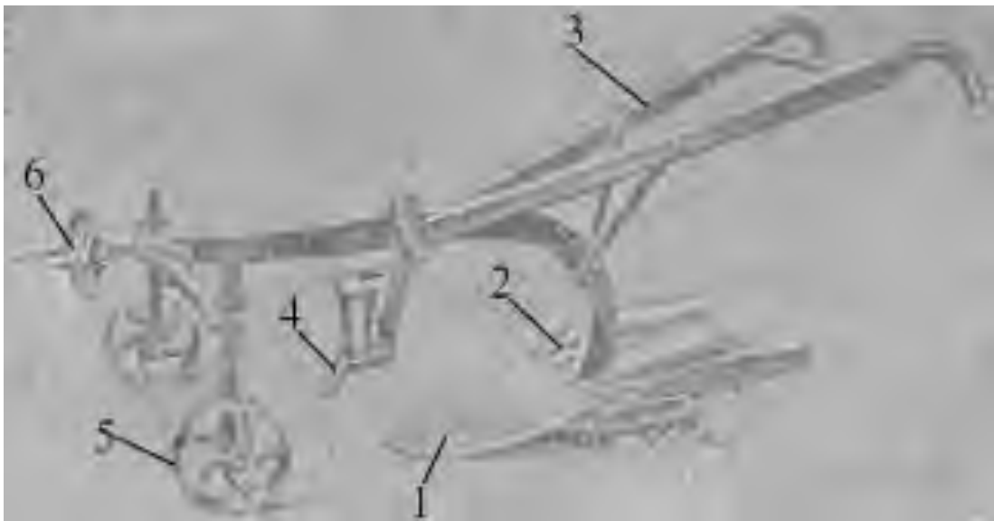
Рис. 9. 2. Плуг-копач з коливною решіткою: 1 – лемішок; 2 – пальцева решітка; 3 – рукоятка; 4 – відбивач; 5 – опорне колесо; 6 – причіпний пристрій
