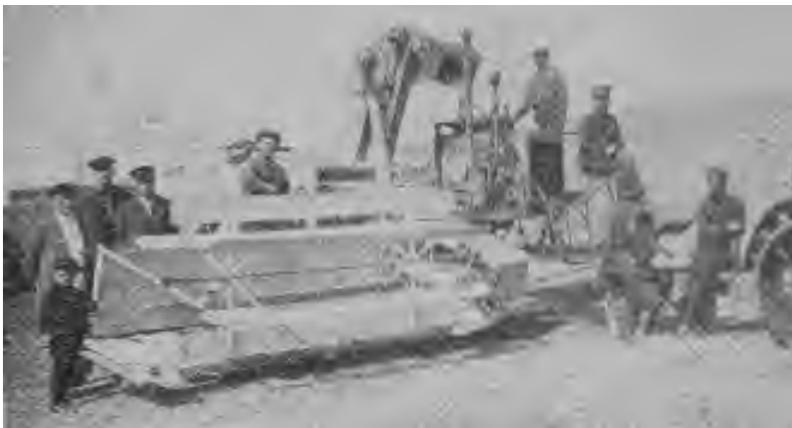
Рис. 8. 48. Зернозбиральний комбайн "Комунар" ЖМ-4,6
