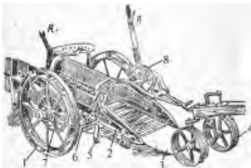
Рис. 9. 8. Копач картоплі однорядковий елеваторного типу: 1 – ходове колесо; 2 – рама; 3 – леміш; 4 – двоколісний передок; 5 – ролик; 6 – елеватор; 7 – зірочка
