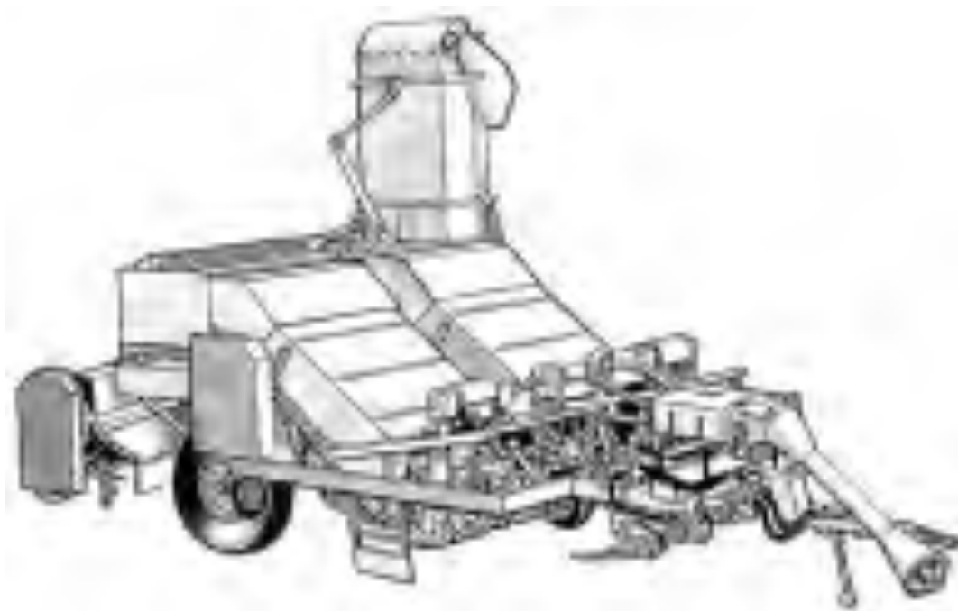
Рис. 9. 33. Гичкозбиральна машина БМ-6Б
