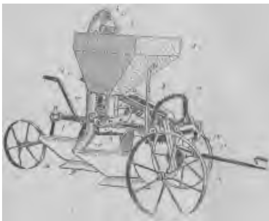
Рис. 5. 44. Машина для садіння картоплі у якої, борознорозкривальним та борознозаготальним робочим органом є корпус плуга
