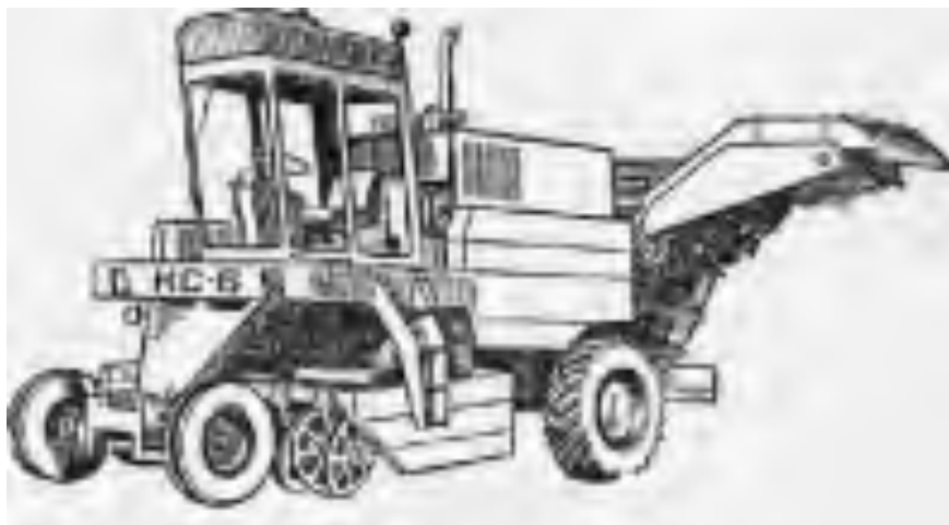
Рис. 9. 34. Коренезбиральна машина КС-6
