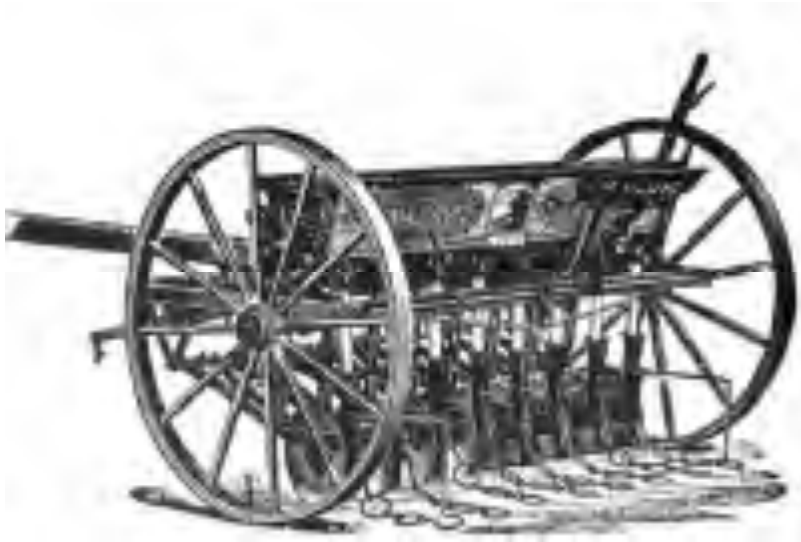
Рис. 5. 18. Кінна сівалка з катушковим (Гузьєровським) висівним апаратом та однодисковими сошниками
