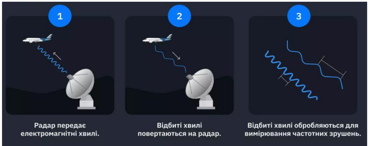
Рис. 1.3. Принцип роботи RADAR сканування [17]
