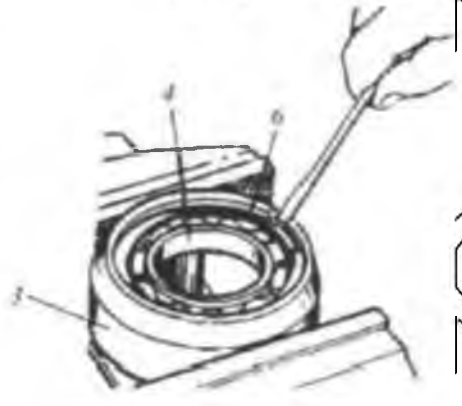
Рис. 1.20. Зніміть стопорне кільце 6 і випресуйте шарикопідшипник 4.
