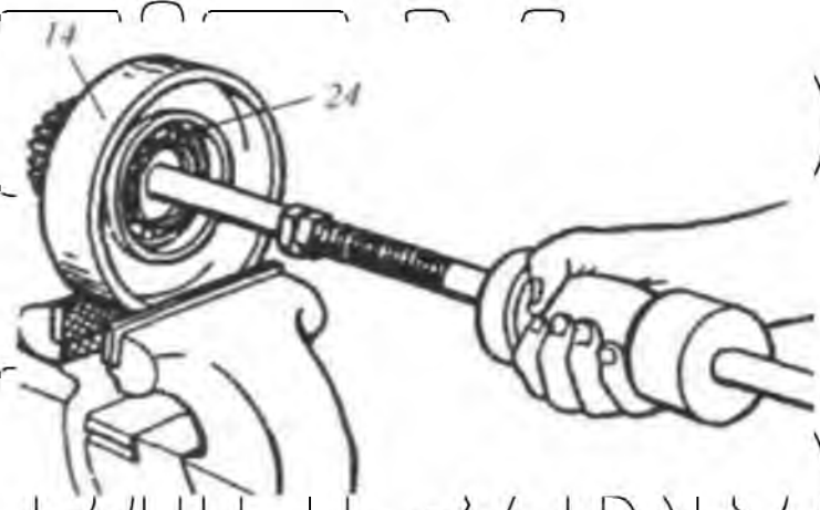
Рис. 1.11. Випресування підшипника 24 з барабана 14 за допомогою інерційного молотка.
